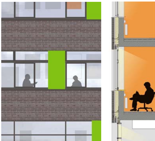
Abbildung 7 Ansicht und Fassadenschnitt
