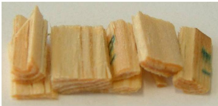
Abb. 15 Zerstörte Kiefernholz-Probe (tangentiale Druck-Belastung)
