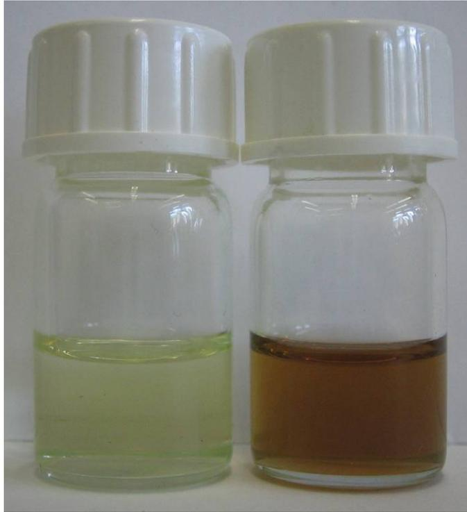
Abbildung 28: Stabilität von Silber-Nanopartikeln in einem Zinnbad
