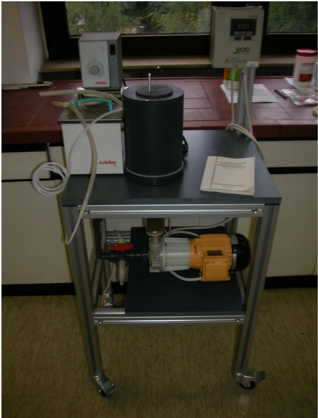
Abbildung 29: Laboranlage für Beschichtungsversuche im 1 Liter-Maßstab
