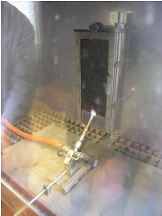
Bild 6 Prüfapparatur Brandverhalten
