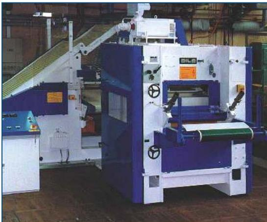
Bild 2 DILO Versuchsnadelmaschine
