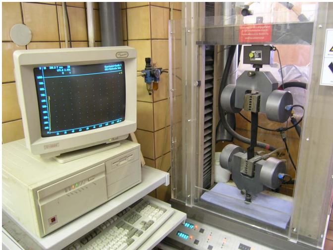
*Bild 5 Zugprüfmaschine*
