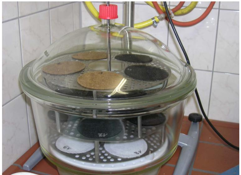
Bild 7 Prüfapparatur Feuchtigkeitsaufnahme
