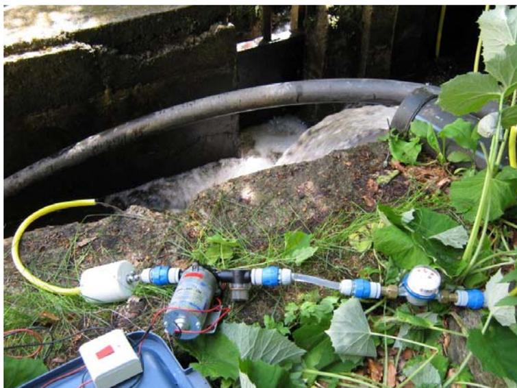
**Bild 1.** Beispiel einer Probenahme des Wassers über Filta-Max Foamfilter
