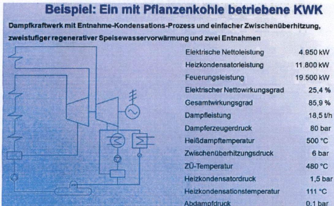
Abbildung 67: Beispiel eines mit Pflanzenkohle betriebenes KWK
