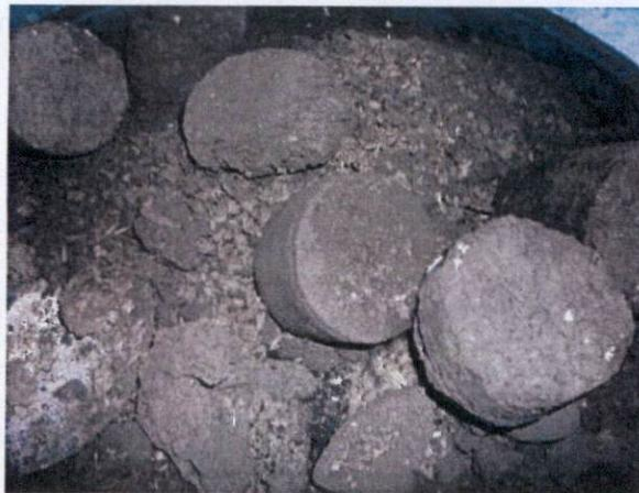
**Abbildung 57: Durch die Entnahmepresse ausgeworfenen Biokohle-Presslinge**
