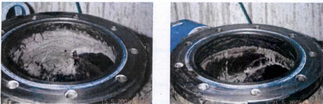
Abbildung 15: Kruste an der Innenwand des Laborreaktors nach der 7. (links) bzw. nach der 20. Abwasserfahrt (rechts)
