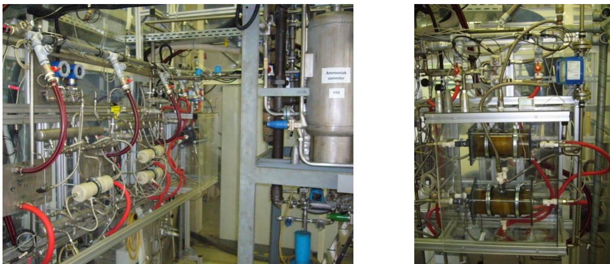
Abbildung 5.6: Membranabsorberprüfstand TU-Berlin (links), Abkapselung der simultangekühlten Membranabsorber mit Plexiglas (rechts)
