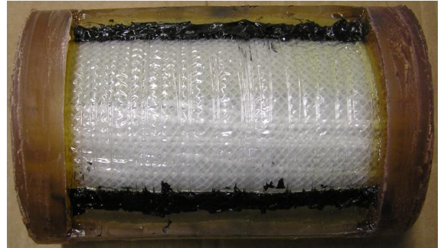
Abbildung 7.3: Wickel mit den geharzten Stirnseiten und den bereits angebrachten Seitenkanälen
