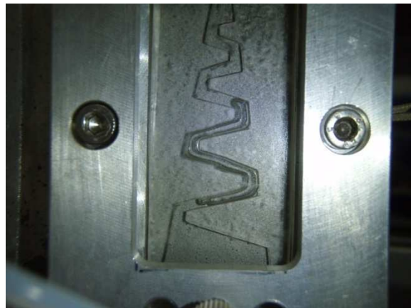
Abbildung 2.33: Foto eines Thermischen Trennmoduls im Betrieb
