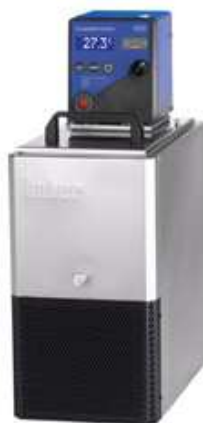
Abbildung 2.39: Huber-Polystat zur Temperierung der Mikroreaktoren
