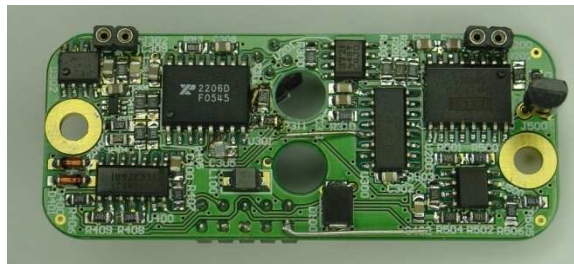
Abbildung 2.58: Fertig bestückte und funktionsfähige Platine
