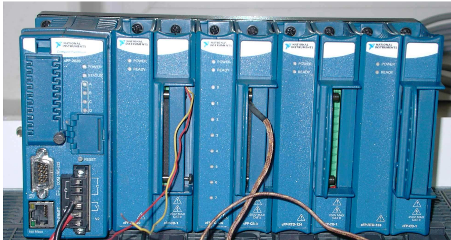
Abbildung 2.41: Steuerung der mikroverfahrenstechnischen Anlage durch ein Compact FieldPoint System der Firma National Instruments
