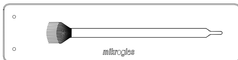
Abbildung 2.10: Mikromischer mit langem Verweilkanal
