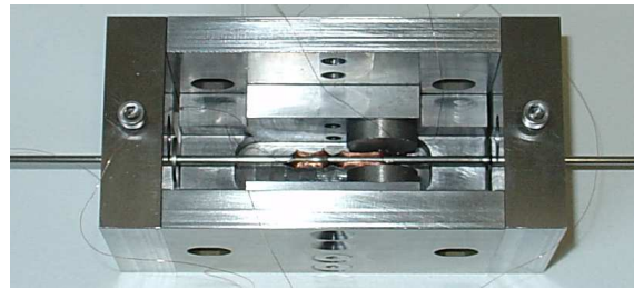
Abbildung 2.55: Mechanischer Aufbau des Viskositätssensor
