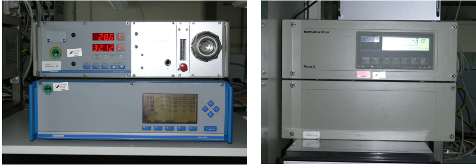
Abb. 19: Messgeräte zur Bestimmung der Gaskonzentrationen nach der Abreinigung (links: Rosemount NGA 2000 und Rosemount Binos 100 2M; rechts: Hartmann & Braun Radas 2)
