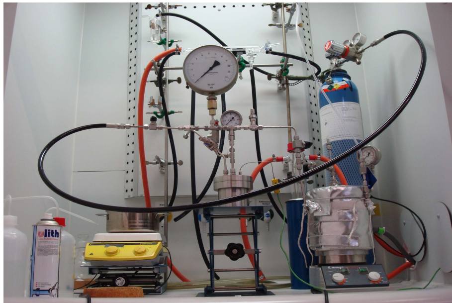
Abb. 5: Screening-Anlage zur Gaslöslichkeitsmessung in ionischen Flüssigkeiten
