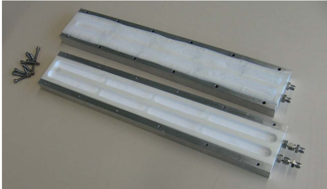
Abb. 12: Membrantrenneinheit für den Einsatz von IL-Membranen zur Gastrennung (200 cm 2 )
