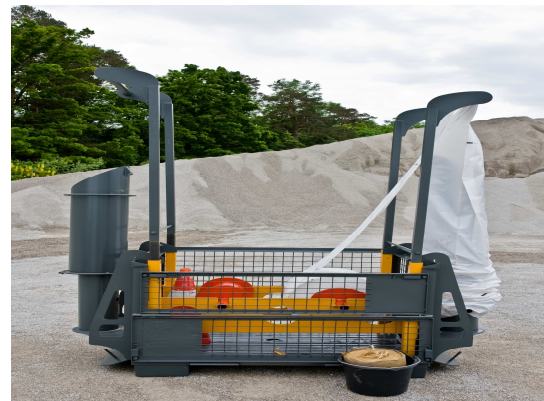
Foto 8: Raffvorrichtung f. den Folienschlauch
