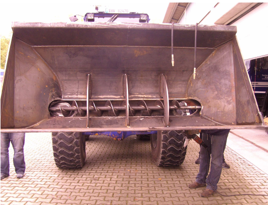
Foto 1: Prototype, Radladerschaufel mit querliegender Förderschnecke (= Förderschäufel)
