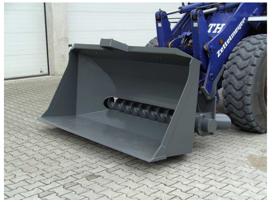
Foto 4: Zweiter Prototyp, neue Förderschäufel
