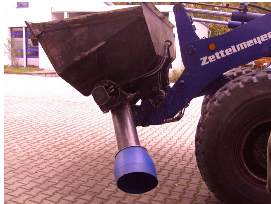
Foto 2: Förderschäufel mit Füllrohr + Adapter
