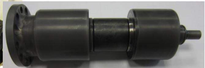
Bild 9: Neufertigung Wellenverbund Lagerprüfstand
