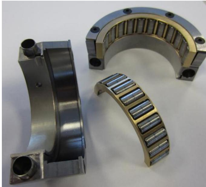
Bild 23: Hauptlagerring mit neuer adaptiver Lagerung
