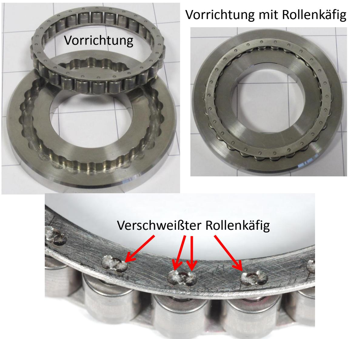
Bild 4: Verschweißen des Rollenkäfigs
