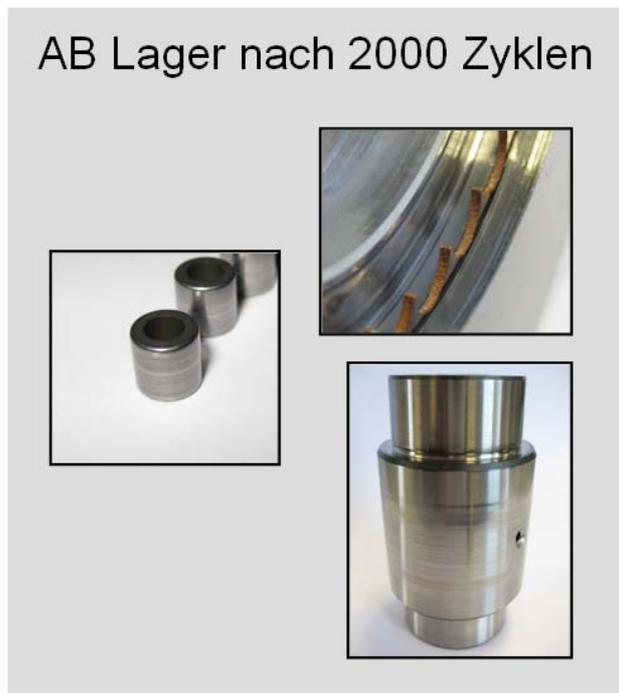
Bild 29: Lastprofil und Komponenten des ersten Dauerlaufs
