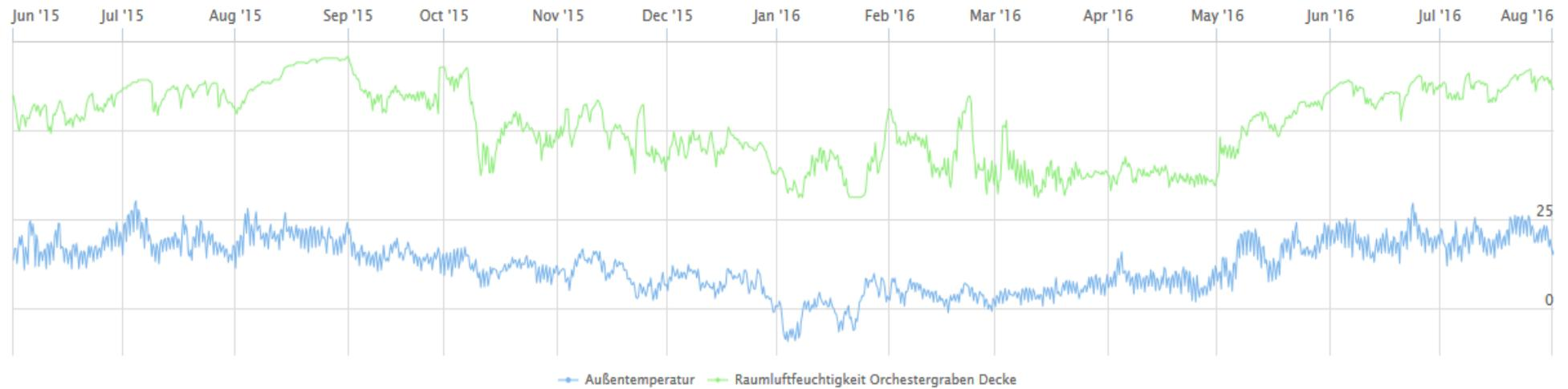
Außentemperatur, Raumluftfeuchtigkeit Orchestergraben unter der Decke, Referenzjahr, [°C/%] (Abschlussbericht Abb.113)
