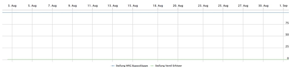
Abb.167 RLT-Anlage für Haupt-/Saalgebäude Bypassklappe und Ventil Erhitzer Stellung im August 2015, [0 % – Bypass/100% – WRG, 0 % – Ventil zu/100% – Ventil auf]
