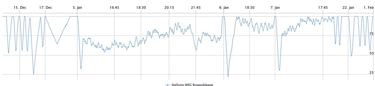
Abb.168 RLT-Anlage für Haupt-/Saalgebäude Bypassklappe Dezember 2015 – Januar 2016, [0 % – Bypass/100% – WRG]
