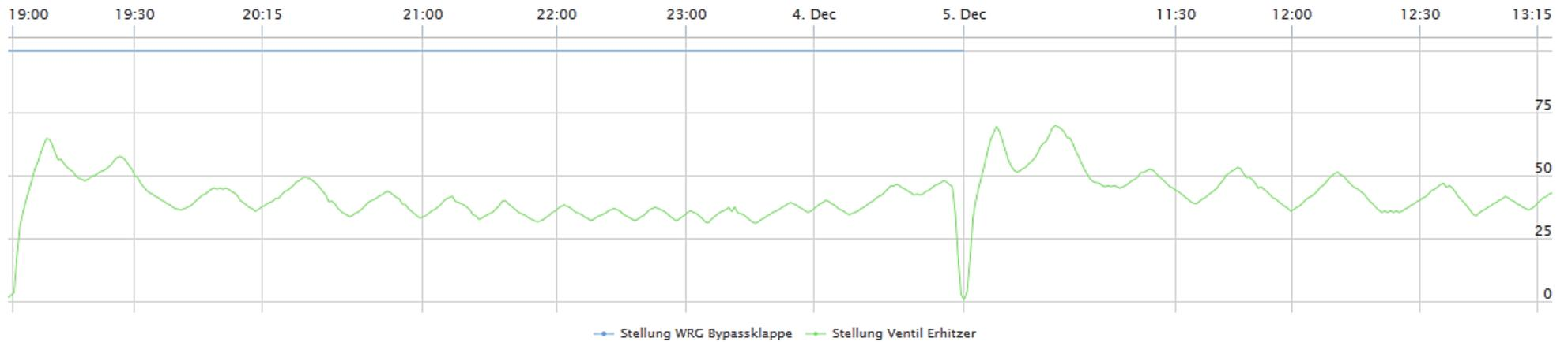
RLT-Anlage für Haupt-/Saalgebäude Bypassklappe und Ventil Erhitzer Stellung 2.12.2015 – 5.12.2015, [0 % – Bypass/100% – WRG, 0 % – Ventil zu/100% – Ventil auf] (Abschlussbericht Abb.177)
