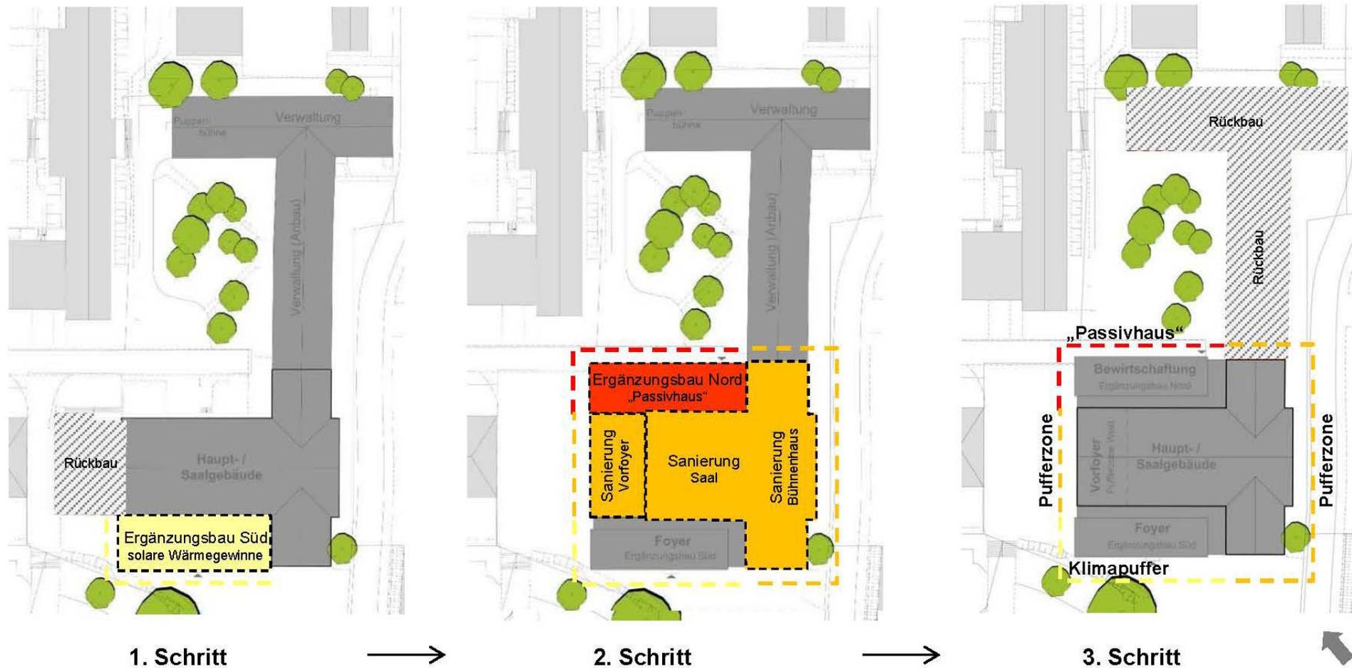
1. Bauabschnitt Anbau eines neuen Foyers an der Südwestfassade als Pufferzone zum Außenraum für solare Wärmegewinne und Rückbau des alten Foyers (der 1. Bauabschnitt erfolgte vor Projektbeginn 2.BA)
