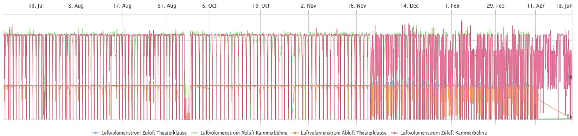
Luftvolumenstrom RLT-Anlage für Ergänzungsbau Nord(ost), Referenzjahr, [m<sup>3</sup>/h] (Abschlussbericht Abb.185)
