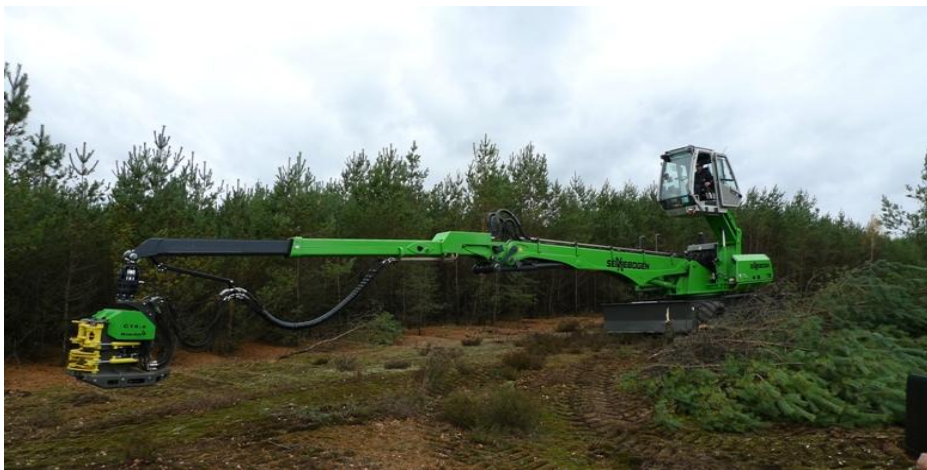
Abb.19: Neue Energieholzerntemaschine mit 13m Reichweite (Foto Appelfelder)
