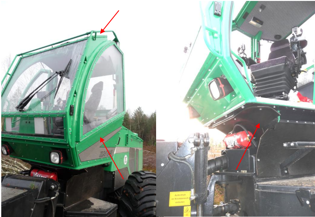
Abb. 9. Munitionsschutz an der Kabine des Harvesters
