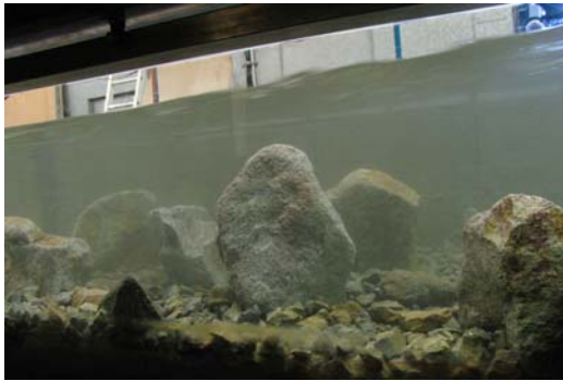
Abbildung 4.28: Ausgeprägte Rauigkeiten werden bei Fließgeschwindigkeiten ab 0,4 m/s von leistungsschwachen Fischen gemieden, ...
