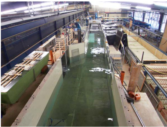
Abbildung 3.5: Ethohydraulischer Versuchsstand im Betrieb mit Hälterbecken
