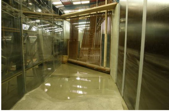
Abbildung 3.17: Untersuchung eines schwenkbaren, so genannten Chan-Bar-Rechen, der dem Schutz abwandernder Fische dient
