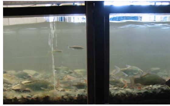
Abbildung 4.29: ... während sie in Abschnitte mit wenigen, maximal 15 cm über die Sohle aufragenden Rauigkeitselementen ausweichen
