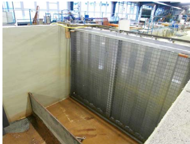
Abbildung 3.18: Feinmaschige Fluchtsperre vor den Auslaufplatten der Laborrinne
