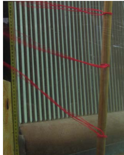
Abbildung 4.19: Entsprechend der Strömungsgradienten ausgelenkte Fäden einer einfachen Fadenharfe vor einem sohlennah verschlossenen Bypasseinlauf
