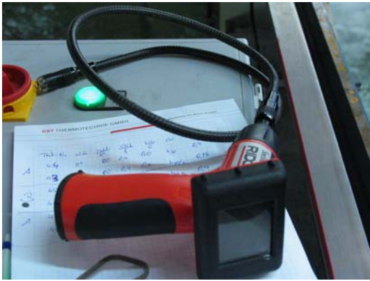
Abbildung 4.15: Das Unterwassersichtbeobachtungsgerät mit verlängerter Linse war erst dann nutzbar, als der Boden der Laborrinne weiß gestrichen in diesem Bereich ein größerer Kontrast zu den zu beobachtenden Fischen gegeben war
