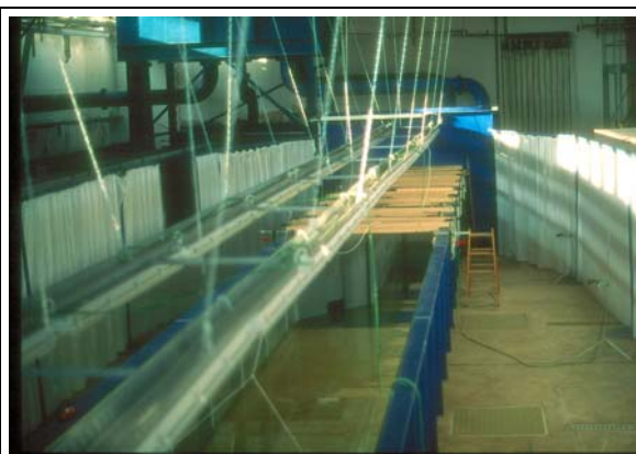
Laborrinne an der ZALF in Müncheberg: Länge: 18,0 m Breite: 1,5 m Einstautiefe: 0,3 m
