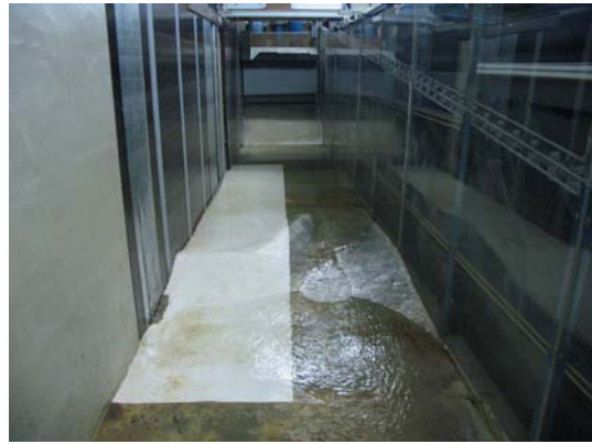
Abbildung 4.15: Das Unterwassersichtbeobachtungsgerät mit verlängerter Linse war erst dann nutzbar, als der Boden der Laborrinne weiß gestrichen in diesem Bereich ein größerer Kontrast zu den zu beobachtenden Fischen gegeben war
