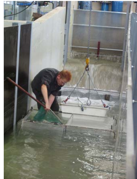
Abbildung 4.3: Umsetzen von der Transportwanne in den Startkäfig in der eingestauten Rinne
