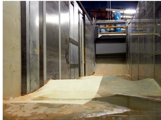
Abbildung 3.8: Untersuchungsbereich mit natürlicher Sohlengeometrie
