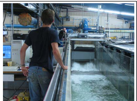
Laborrinne am IWG in Karlsruhe: Länge: 17,0 m Breite: 1,75 m Einstautiefe: 1,0 m
