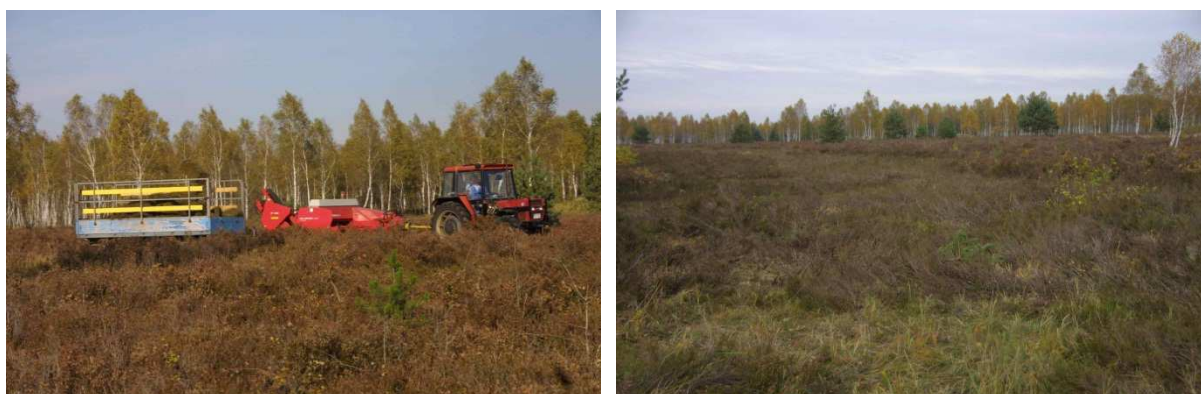
Abbildung 15: Heidemahd im Herbst 2010 mit einem Doppelmessermähwerk mit kombinierter Ballenpresse und Ladewagen (links), Heidebestände unmittelbar nach der Mahd im Herbst 2010 (Bildmitte), angrenzend ungemähte Heidebestände (rechts). Fotos: A. Lorenz
