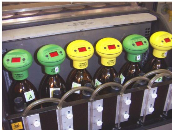
Abbildung 58: BSB-Flaschen mit aufgesetzten Drucksensoren
