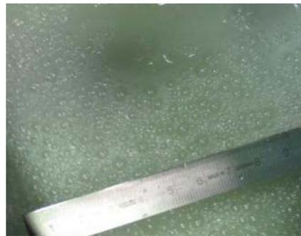
Kühlschmierstofftank nach der Zugabe des Entschäumeradditivs
