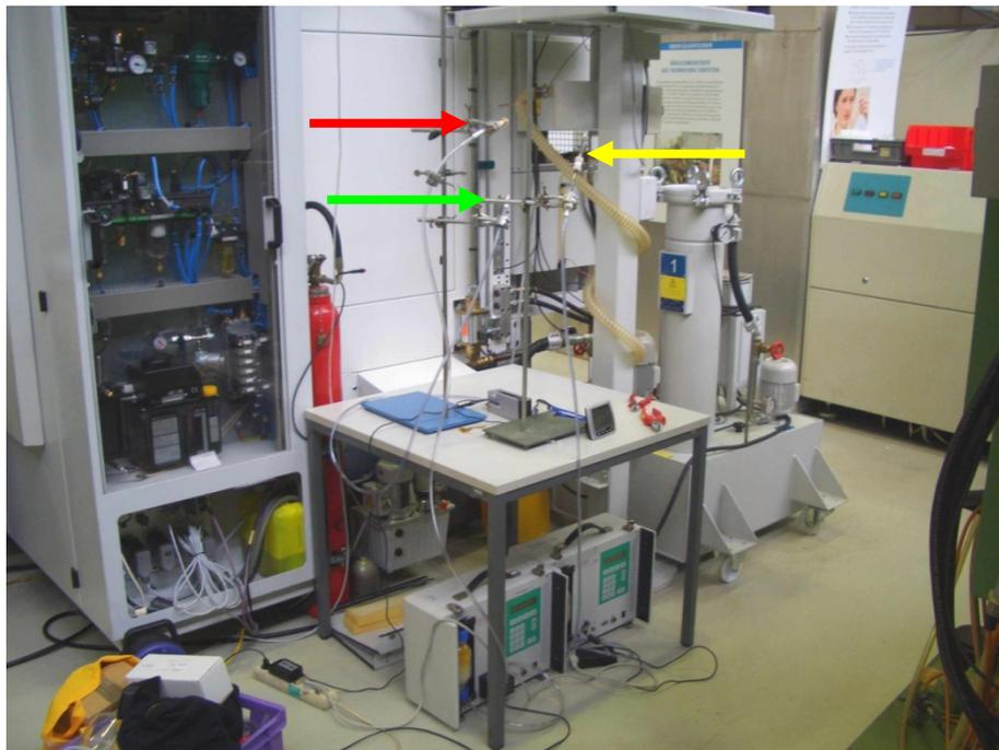
Abbildung 71: Luftprobenahme hinter der Studer S 120
