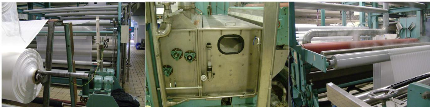
**Abb. 26: Waschmaschine zur Vorwäsche und Fixierung der Partien**
