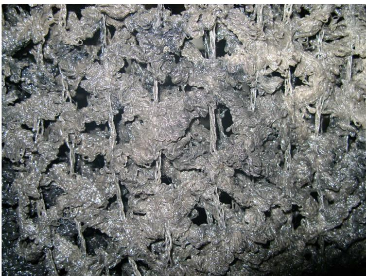
**Abb. 6: Mikroorganismenbewuchs auf einem Textilträgermaterial**
