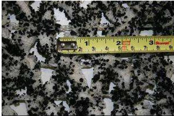
**Abb. 12: Textiles Trägermaterial mit aufgerieselten Braunkohlekokspartikel**
