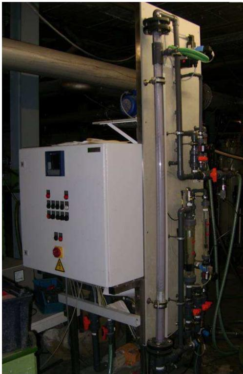
**Abb. 9: Low-Energy Ultrafiltrationspilotanlage**
