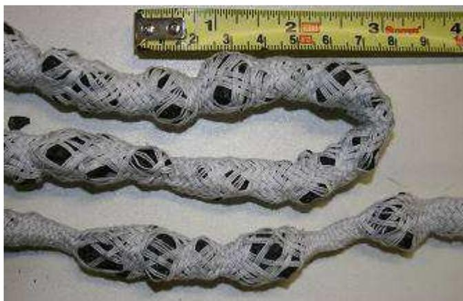
**Abb. 13: Offener Geflechschlauch mit Braunkohlekokspartikel**
