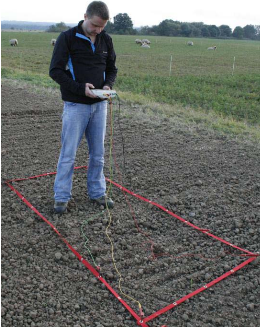
Abb. 36 Referenzmessungen mit fixen Elektroden zur Beurteilung der GEOPHILUS-Daten (aus: Meschzan, 2010)
