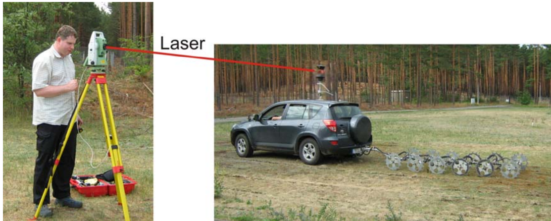
Abb. 11 Messwertpositionierung über Tachymeter
