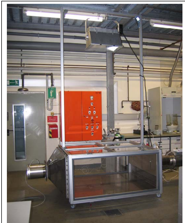
Abb. 20: Aufstellung der mobilen Messkammer im Technikum (1); oben ist die HQI-Lichtquelle zu sehen
