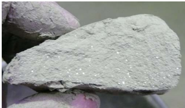
Abb.16: Entmischungen in verfestigtem Zement
