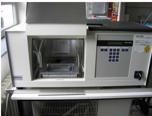
Abb. 1: Bestrahlungseinheit der Messapparatur nach ISO 22197-1
