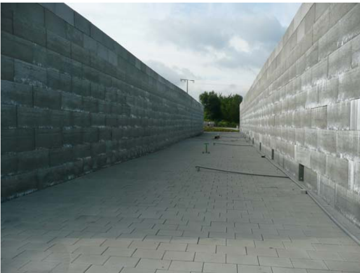
Abb.38: Canyon-Testfläche – Belegung photokatalytisch wirkendes Pflaster
