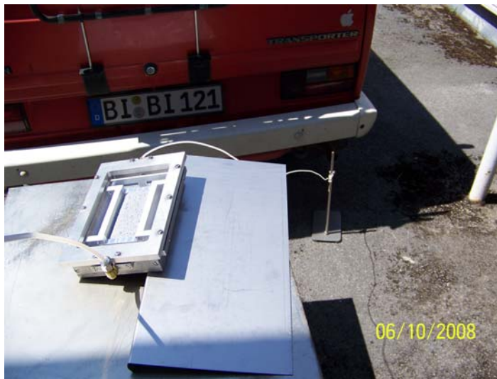
Abb. 26: ISO-Messkammer, direkte Sonnenbestrahlung
