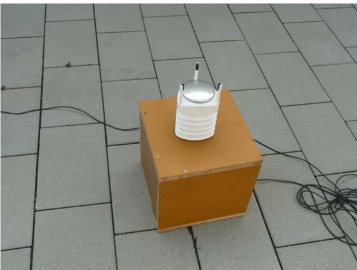
Abb.42: Windmesser, Meteo-Multigeber FMA 520 , Messung im Canyon
