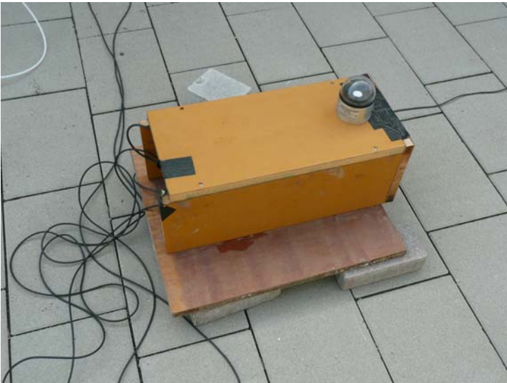
Abb.41: Helligkeitsmesser, FLA 13 VLM , Messung im Canyon
