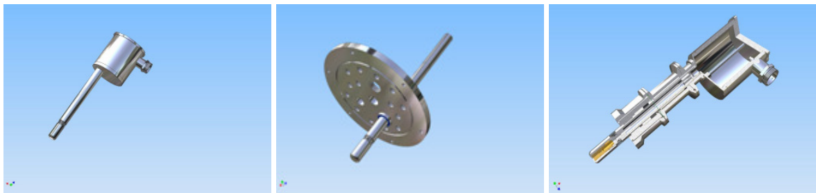
Abbildung 4: LHP Varianten: manuelle Laborsonde (l.), Sonde eingebaut in Bioreaktor (M.) und halbautomatische Sonde (r.)
