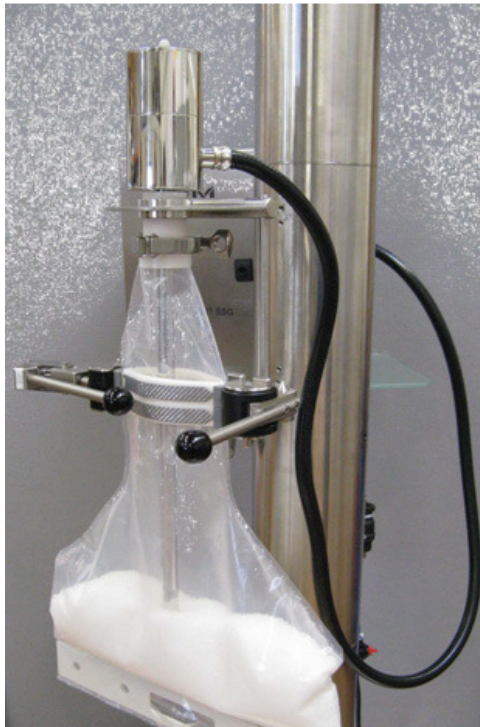
Abbildung 8. TC-LHP angepasste für abgeschlossene Pulveranalyse (l.) und NIR-Spektrum des Pulvers (r.).
