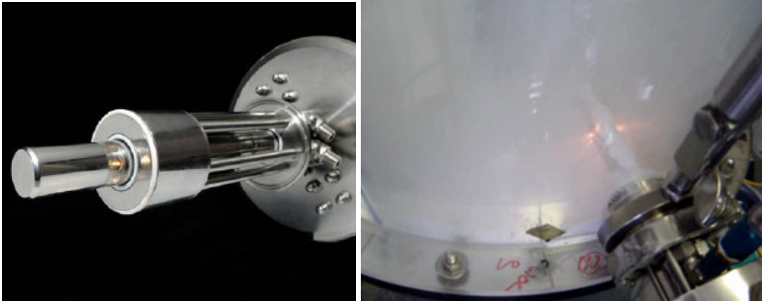
Abbildung 1: Lighthouse-Sonde mit Reinigungseinheit: Messkopf (l.), Prozesseinsatz (r.)
