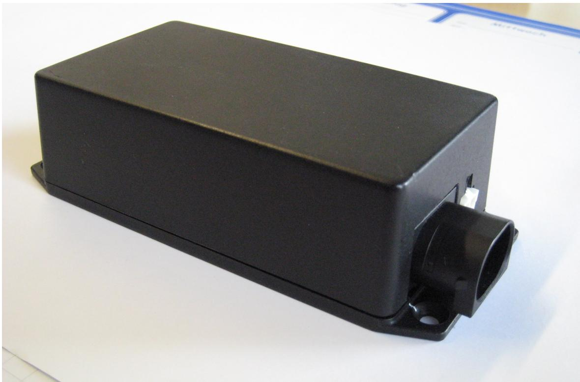
**Abbildung 4.16 : Steuergerät mit Kunststoffgehäuse**
