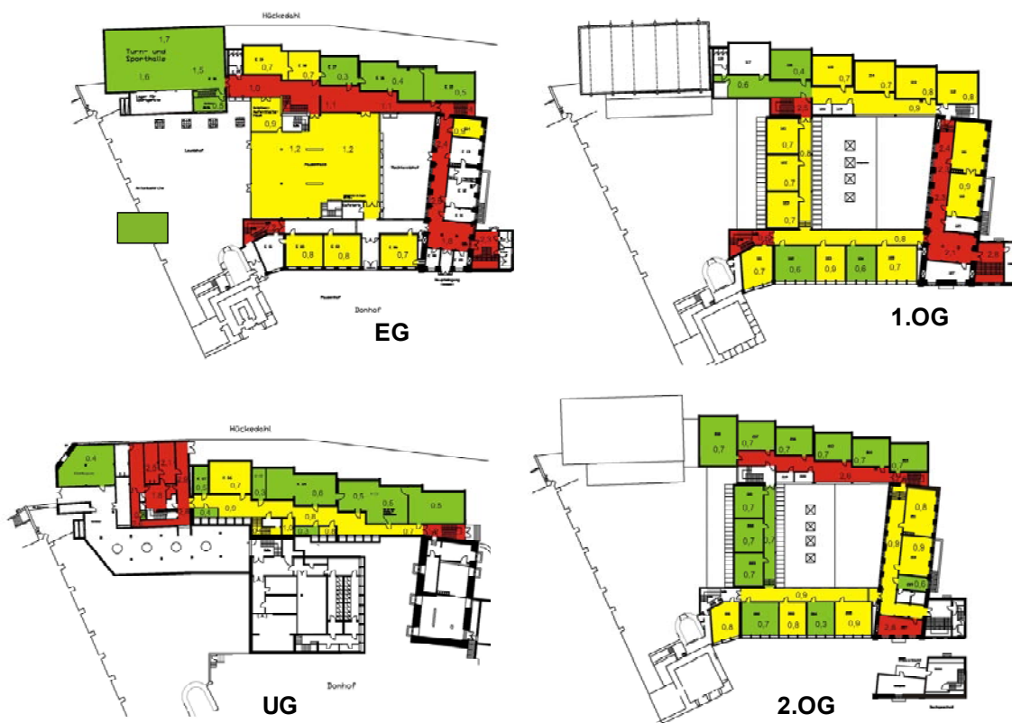
Bild 242 Überblick über akustische Bewertung und Einstufung der Nachhallzeitverhältnisse in allen Gebäudeteilen der Schule
