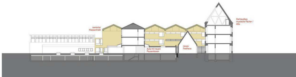
Bild 271 Schnitt: Markante Dachformen der „Häuser im Haus“
