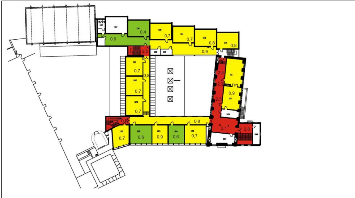
Bild 247 Nachhaltzeit-Messergebnisse und Einstufungen im 1. OG
