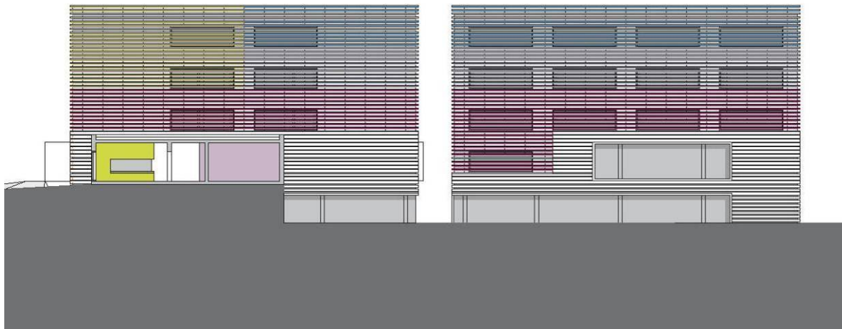
Bild 133 Fassadenstudie horizontale Metalllamellen.
