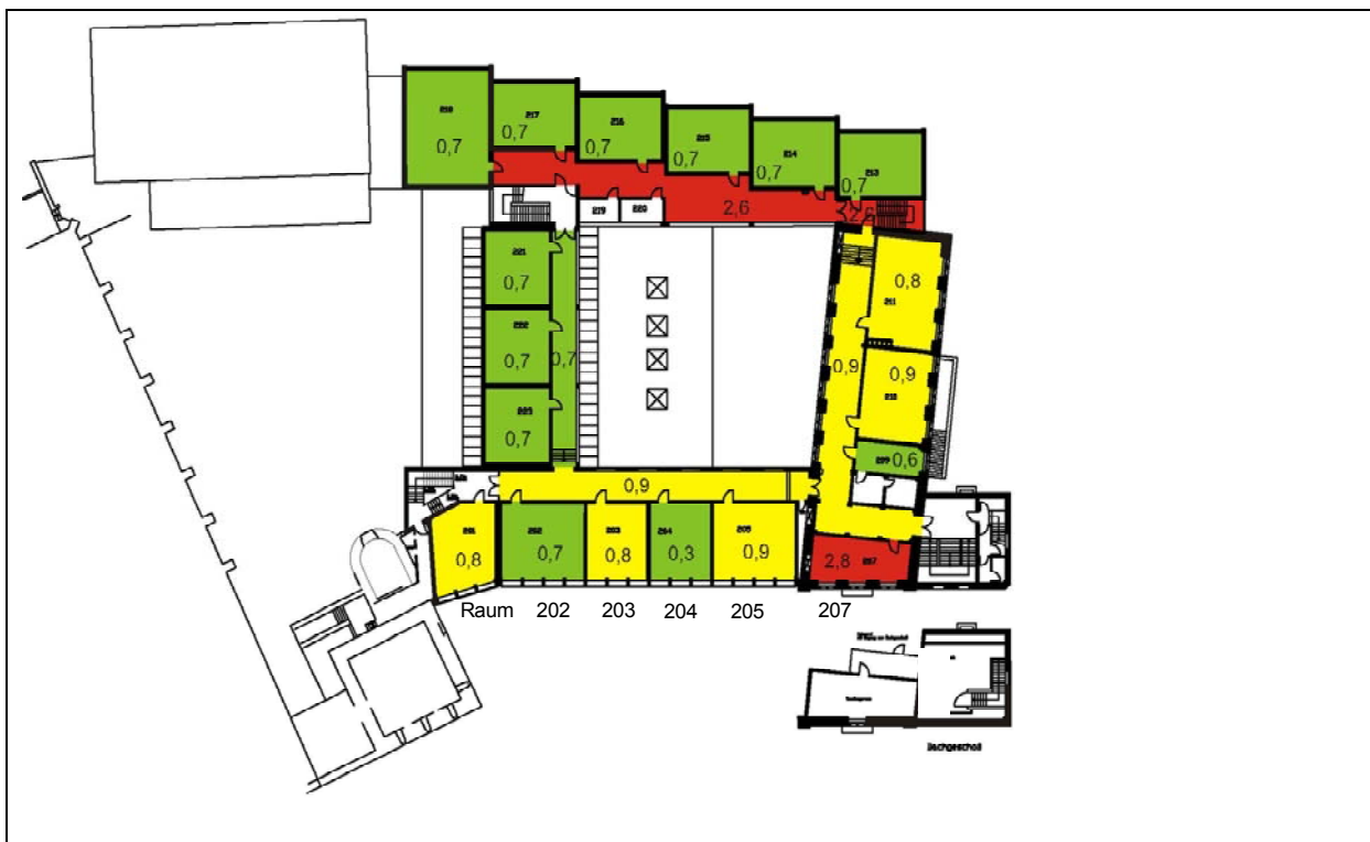
Bild 248 Nachhaltzeit-Messergebnisse und Einstufungen im 2. OG
