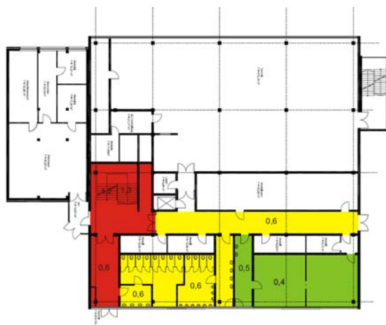
Bild 110 Mittlere Nachhallzeiten und Einstufung im UG
