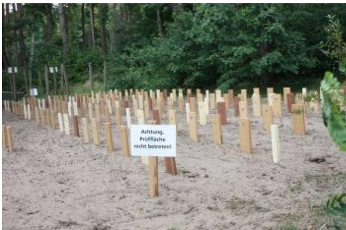
Abbildung 3: Freiland-Versuchsfäche mit WPC-Prüfkörpern im Erdkontakt (WKI).
