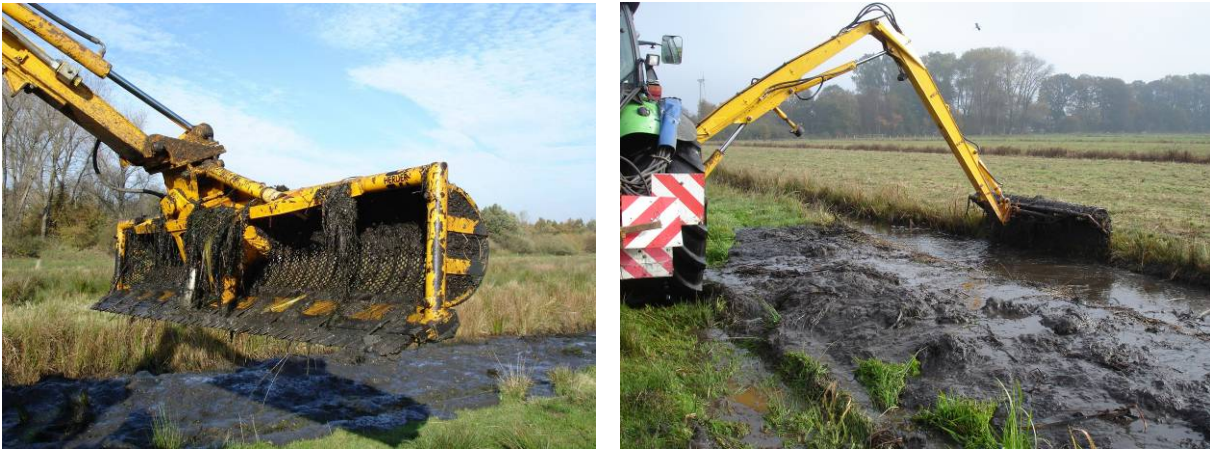
Abb. 7: Mähkorb mit eingelegtem Lochblech und beim Entschlammungs-Einsatz Fotos: R. Kesel
