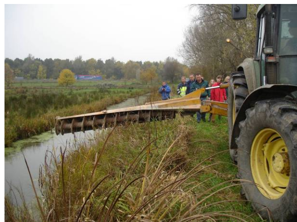
Abb. 9: Der Vijzelslootreiniger in Transportstellung und dessen Arbeitsbreite. Fotos: R. Kesel
