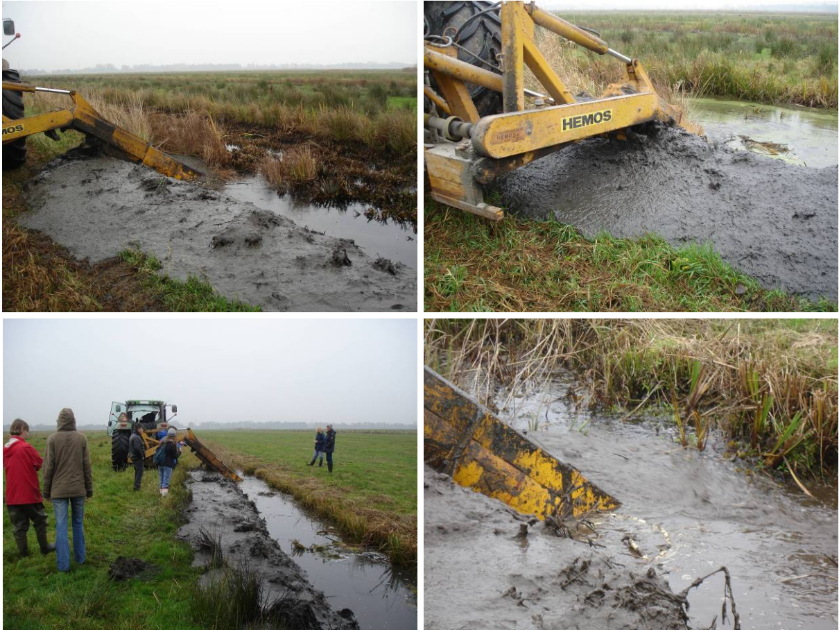
Abb. 10: Der Schraubenräumer beim Einsatz am Kuhgrabenfleet und am Graben Nr. 20. Fotos: R. Kesel
