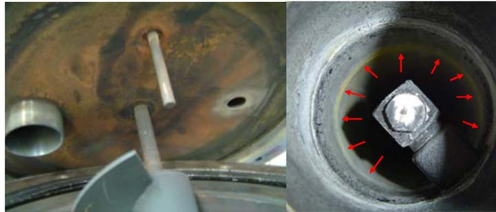
Abbildung 102 Links: Rostspuren nach dem Betrieb mit PPVE-2; rechts: Korrosionsspuren am Quenschenübergang
