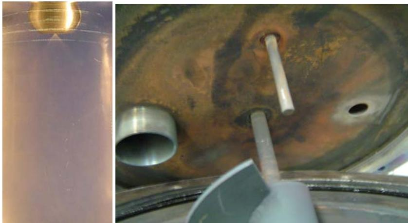
**Abbildung 21** Links: Verdüsungsbild von HFE bei einem Vordruck von 1,5 bar, rechts: Korrosionsspuren am Deckel nach Flüssigversuchen und auf der linken Seite das unkorrodierte, durch die Tangentialströmung geschützte Fallrohr.
