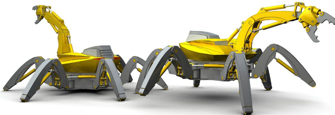
Abb 3: Möglichkeitsstudie „Brachyo“ als autonome Variante und alternativ mit Kabine
