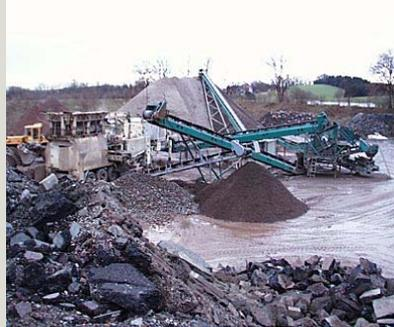
Vorabsiebung und nachfolgende Zerkleinerung der Ausbauelemente bilden die Grundlage für die Erzeugung geprüfter und zertifizierter Recyclingbaustoffe,
