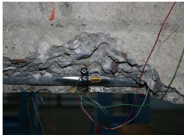
Abb. 12: Freigelegter Bereich zur Ermittlung der Dehnung des Spannstahls unter Lasteinwirkung
