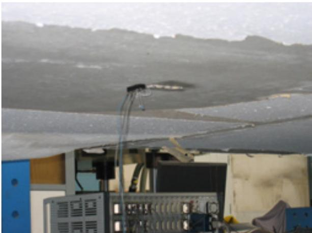
Abb. 11: Dehnmessstreifen in der Zugzone
