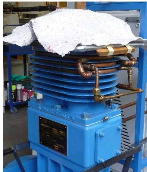
Abbildung 48: Darstellung der Temperaturmessstellen T_6 und T_7 (die elektrische Heizung ist im rechten Bild nicht zu sehen)
