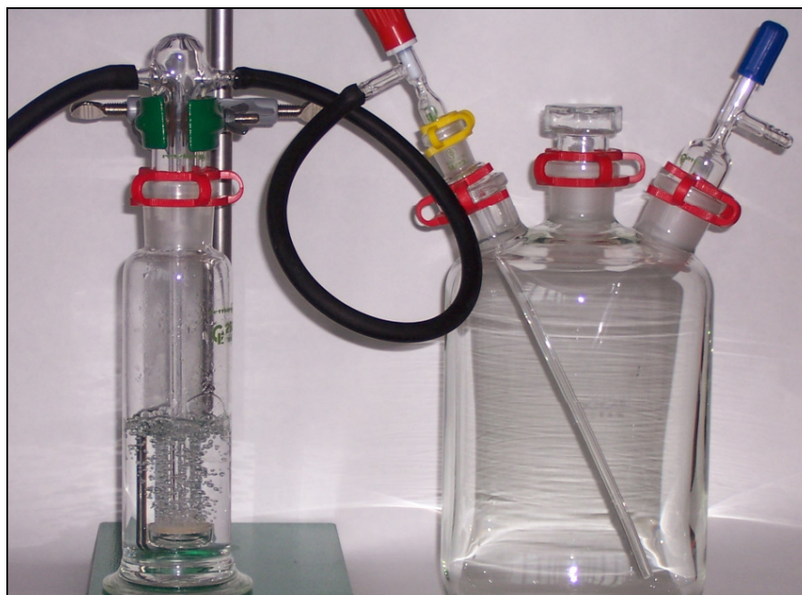
Abbildung 6: Versuchsaufbau zur Erzeugung der feuchten Kohlendioxid-Atmosphäre.
