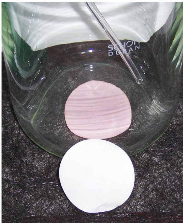
Abbildung 8: Indikatorkreiseln in CO 2 -Atmosphäre (rötlich), davor unkonditioniertes Indikatorkreiseln (gelb-grünlich)
