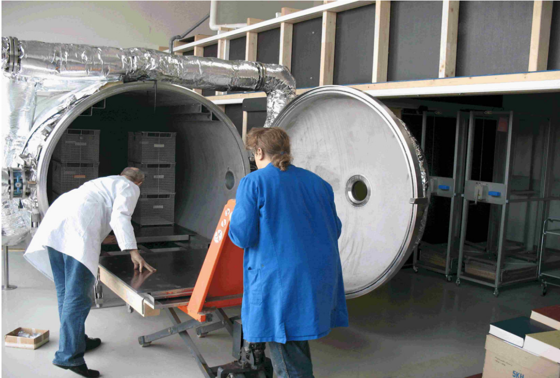
Abbildung 32: Beschickung der thermisch isolierten Röhre mit Behandlungskörben
