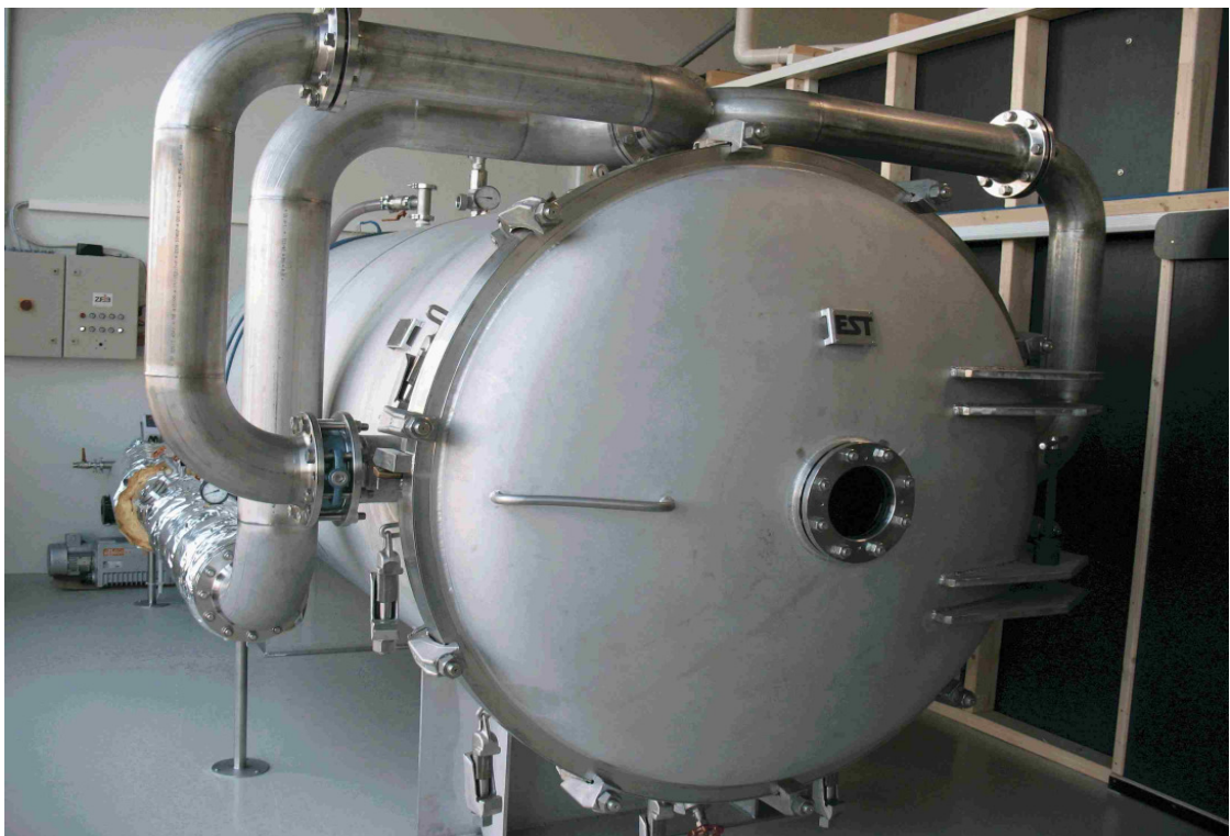
Abbildung 31: Fertig montierte Röhre vor der thermischen Isolierung
