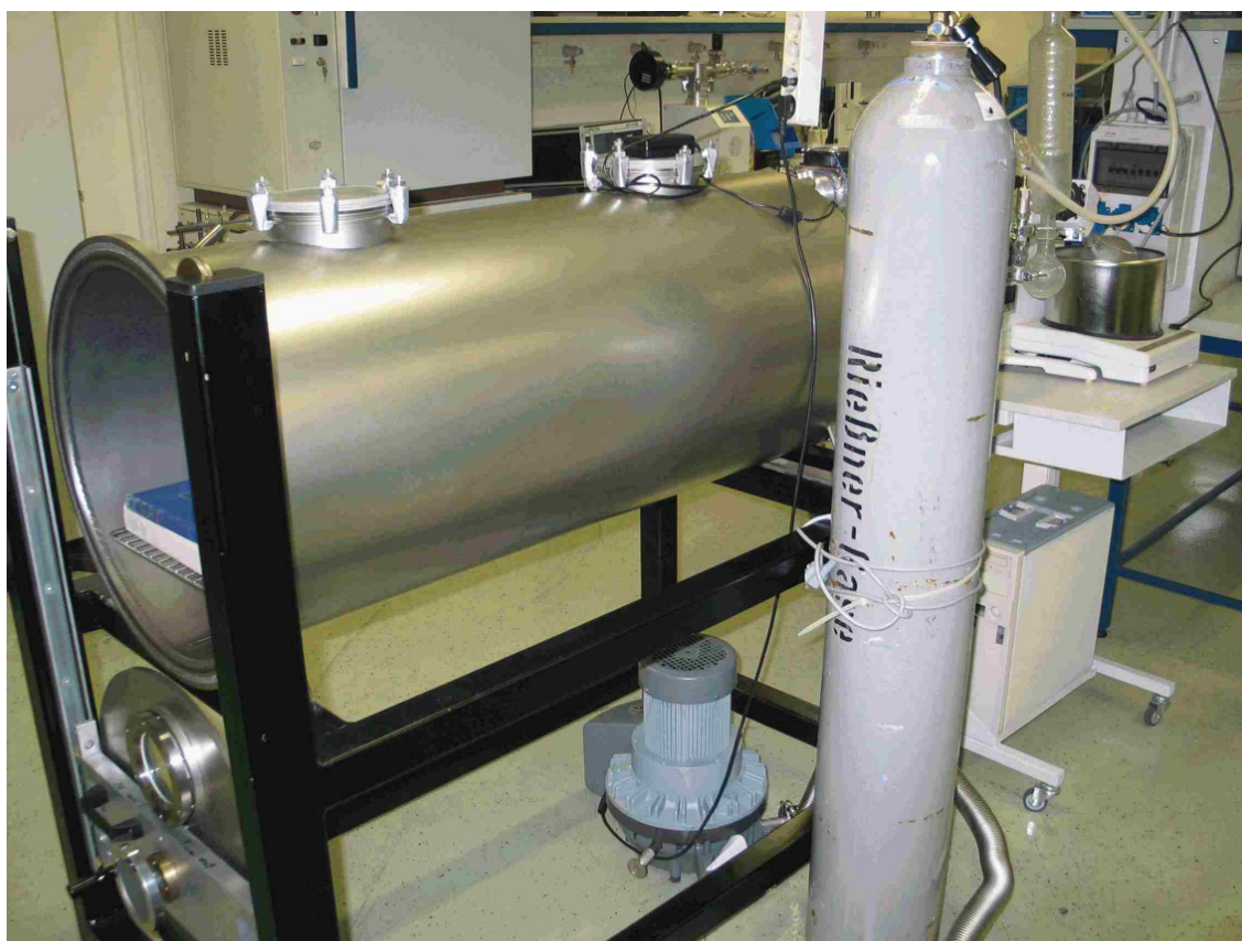
Abbildung 23: Versuchsaufbau mit Vakuumreaktor (220l), Vakuumpumpe, Verdunstungskammer für den Feuchtigkeitseintrag, CO 2 -Flasche
