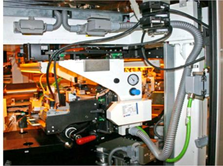
Abbildung 3-16: Druckstation mit Flexodruckwerk
