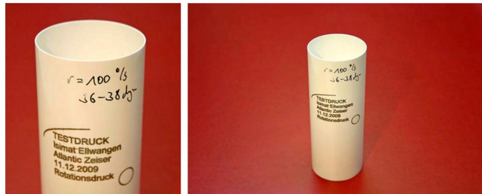
Abbildung 3-11: Testdruck auf Tube im Digitaldruck
