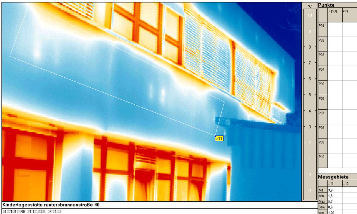
Bild 17: Thermografieaufnahme Ostfassade Bestand
