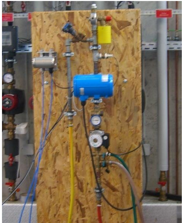
Abbildung 9.1 : Druckverlust-Prüfstand zur Ermittlung der Bauteilverluste
