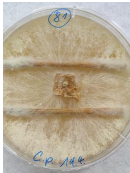
Abb. 5.3.2.2 - 4: Reethalme bewachsen mit Coniophora puteana im Laborversuch nach 21 Tagen Inkubation
