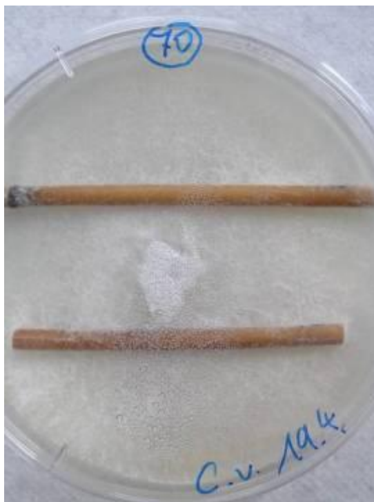
Abb. 5.3.2.2 - 3: Reethalme bewachsen mit Coriolus versicolor im Laborversuch nach 21 Tagen Inkubation
