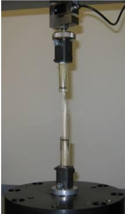
Abb. 2 Zugversuchsordnung eines Reethalmes
