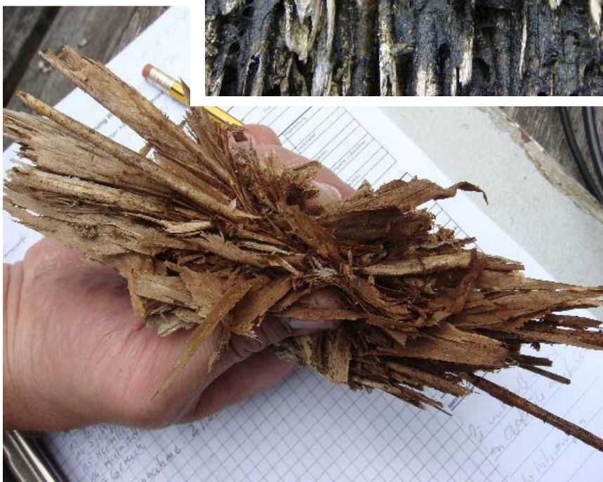
Linkes Bild : Auflösung der Halmstruktur in einem geschädigten Reetdach. Aus der Rotteschicht lassen sich Reste der Halme als Häckselgut leicht entnehmen.
