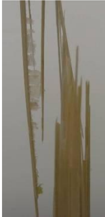
Abb. 3 Reethalm nach dem Zugversuch
