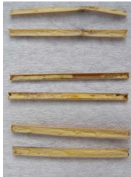
Abb. 5.3.2.2 - 6: drei aufgeschnittene Reethalme, die mit Coniophora puteana beimpft worden waren nach 28 Tagen Inkubation
