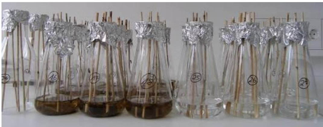
Abb. 5.3.2.2 - 7: Versuchsaufbau mit Reethalmen in Wasser
