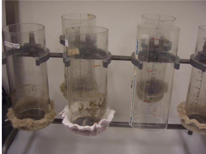
Abbildung 6-6: Versuchsaufbau zur Bestimmung von Filtergeschwindigkeit und –menge
