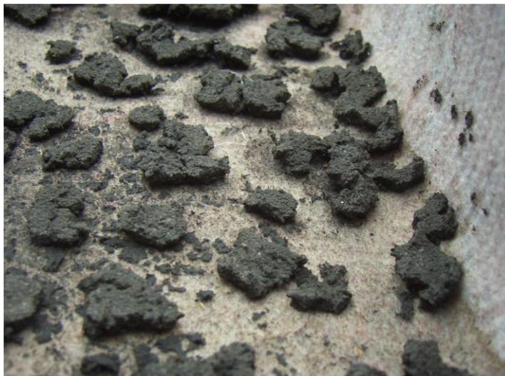
Abbildung 6-15: Gefrierkonditionierter Schlamm im Trockenbeet nach 12 Tagen Trocknungsdauer
