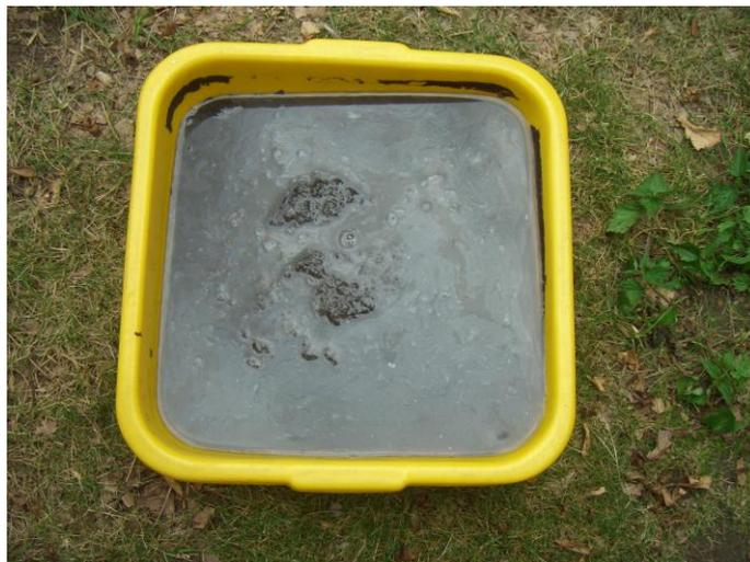
Abbildung 6-10: *Eingedickter Überschussschlamm nach dem Auftauen*
