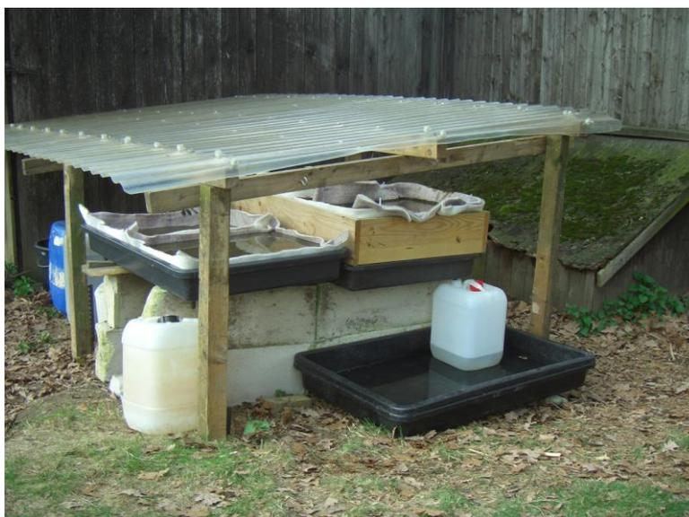
Abbildung 6-1: Die verwendeten Trockenbeete (rechts: tiefe; links: flache Beete)
