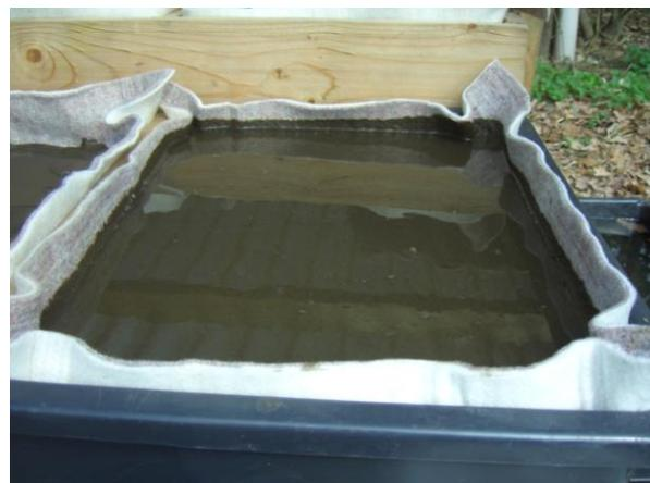
Abbildung 6-2 und Abbildung 6-3: Die flachen Trockenbeete (links: eingedickter Schlamm; rechts: Belebtschlamm mit kurzzeitigem Wasserüberstand direkt nach Schlammzugabe)
