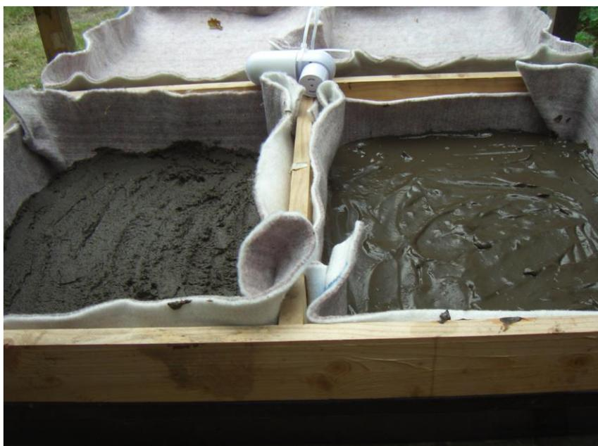
Abbildung 6-13: Gefrierkonditionierter (links) und unbehandelter eingedickter ÜS-Schlamm im Trockenbeet
