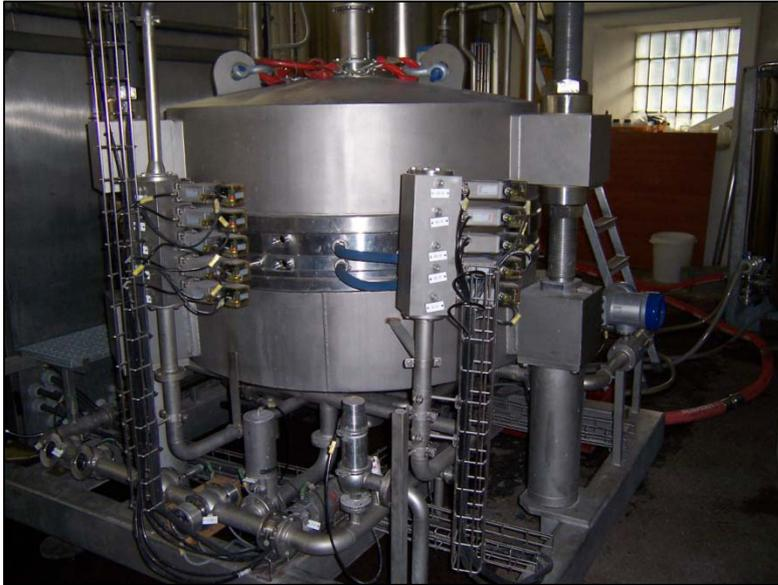
**Abb. 3.7: Pilothorizontalfilter mit 2 Filterelementen**
