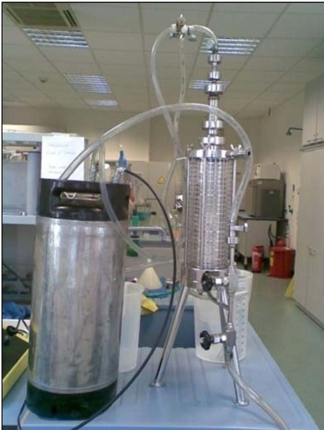
**Abb. 3.15: EBC-Filter zur Bestimmung der Permeabilität nach DARCY**
