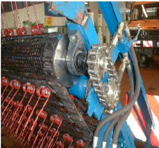
Bild 13 - Hydraulikmotor innen liegend
