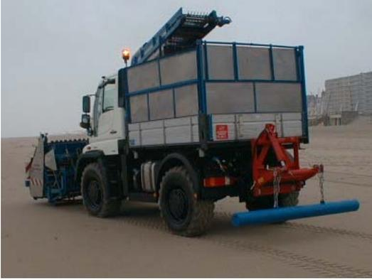
Bild 24 – Planiergerät angehoben
