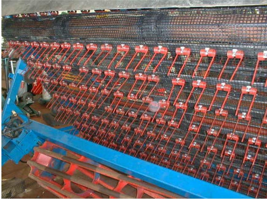
Bild 16 - Aufnahmesiebketten
