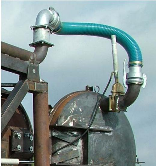
Bild 28 – Fasseinlauf mit Ventil oben
