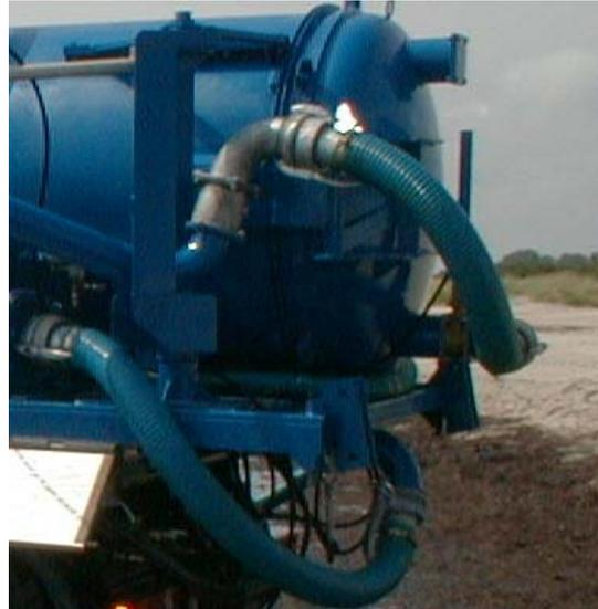
Bild 29 - Fasseinlauf mit Ventil unten
