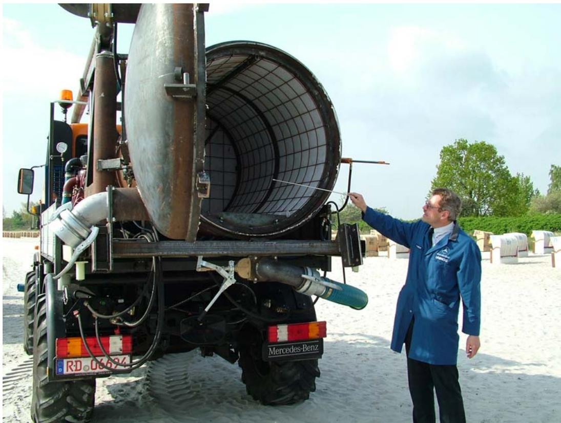
Bild 27 – Filterkorb mit Filtergewebe von innen
