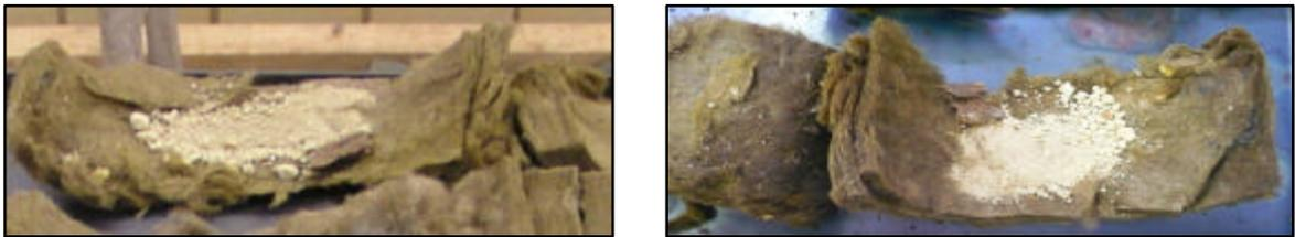
Bild 16: Präpariertes Mineralwollematerial C mit Kronofloc-Filterkuchen vor und nach der Mikrowellenbehandlung
