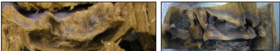
Bild 17: Präpariertes Mineralwollematerial C mit Siliciumcarbid vor (links) und nach der Mikrowellenbehandlung (rechts)
