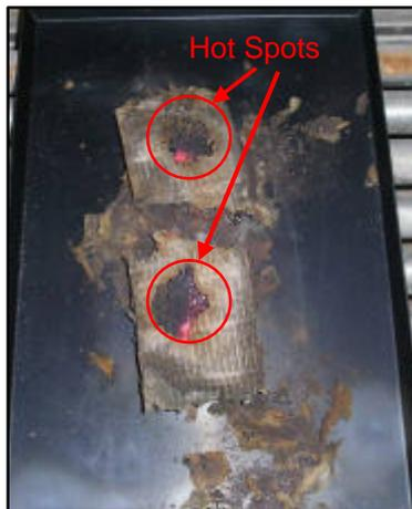
Bild 9: Unterseite der Probe A-1 nach nochmaliger Mikrowellenbehandlung von 2 min
