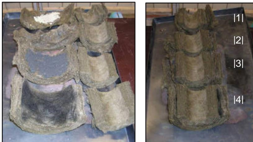
Bild 14: Präpariertes Mineralwollematerial C mit Kronofloc-Filterkuchen|1|, Siliciumcarbid |2|, Kronocarb |3| und Graphitspray |4|
