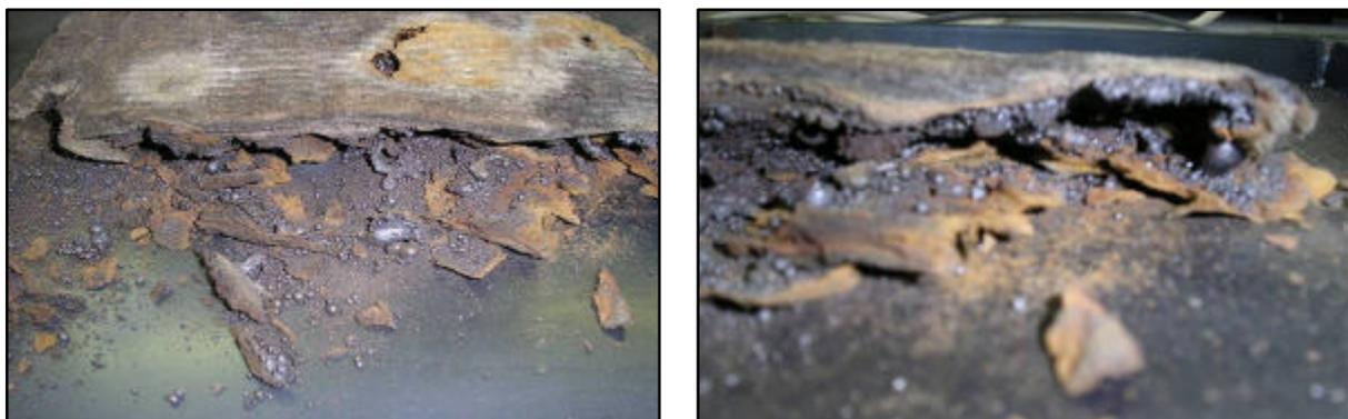
Bild 10: Mit Wasser besprühte Mineralwolleprobe A-2 nach zwei Behandlungsdurchgängen von jeweils 2 min
