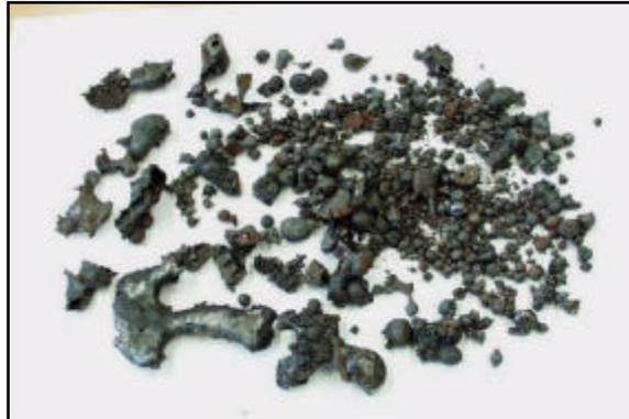
Bild 32: Schlackenrückstände der Mineralwolle A
