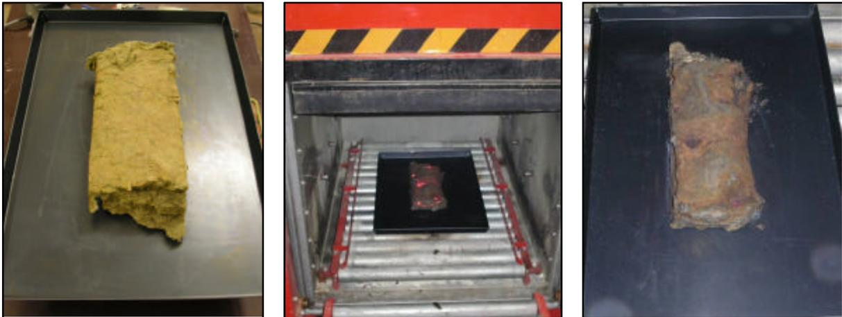
Bild 8: Probe A-1 vor (links) und direkt nach 2 min Mikrowellenbehandlung (Mitte), sowie im abgekühlten Zustand (rechts)
