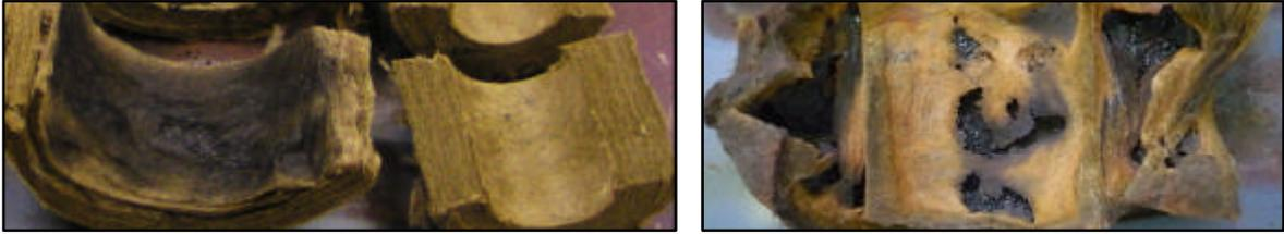
Bild 19: Präpariertes Mineralwollematerial C mit Graphitspray vor (links) und nach der Mikrowellenbehandlung (rechts)
