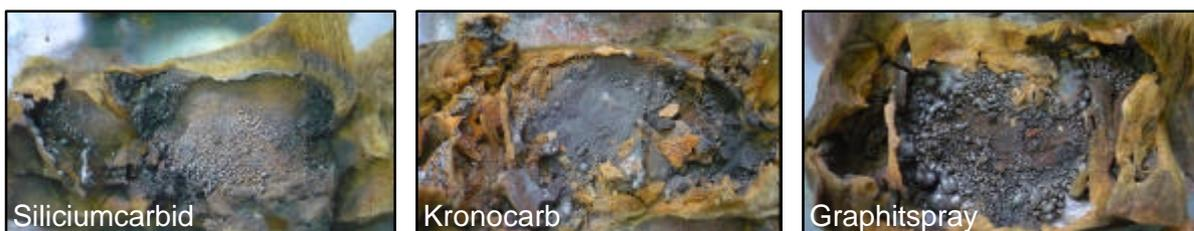
Bild 20: Verschlacktes Probeninneres der mit Suszeptoren präparierten Mineralwolle C nach der Mikrowellenbehandlung
