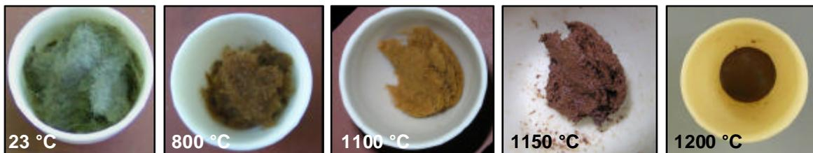
Bild 5: Umwandlung der Mineralwolle (Probe A) in Abhängigkeit von der Temperatur
