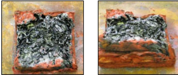
Bild 25: Teilweise erfolgte Verschlackung
