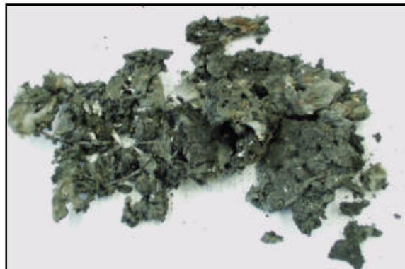
Bild 33: Schlackenrückstände der Mineralwolle B mit Kronocarb
