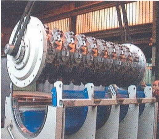
Bild 50: Schneidaggregat [32]
