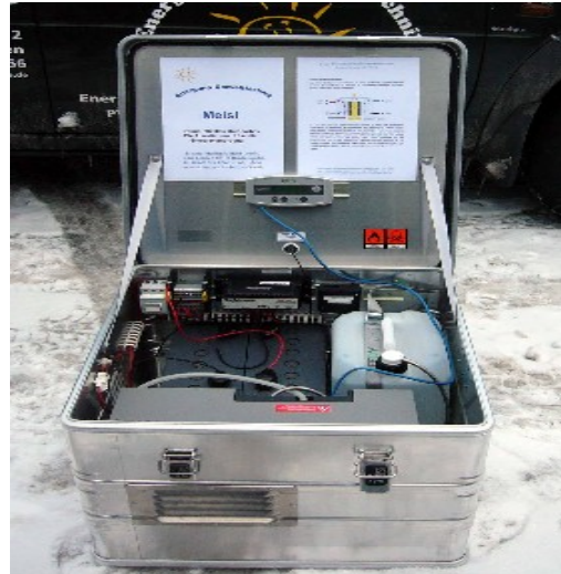
Abbildung 72: Direktmethanol-Brennstoffzelle in Outdoorbox [Elektro Mechanik Meisl GmbH]
