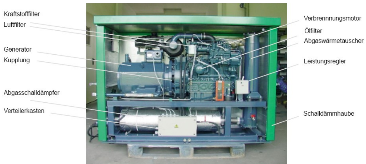
Abbildung 26: Aufbau und Bestandteile eines BHKW [55]
