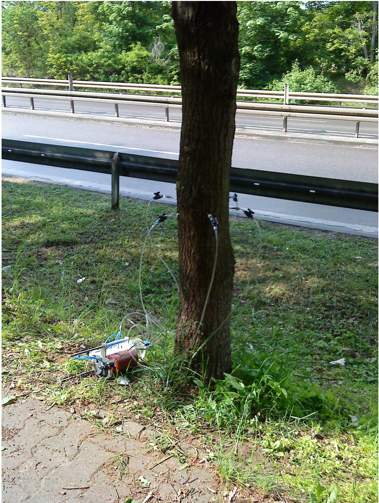
Abb. 30: Stamminjektion an einer urbanen Eiche.
