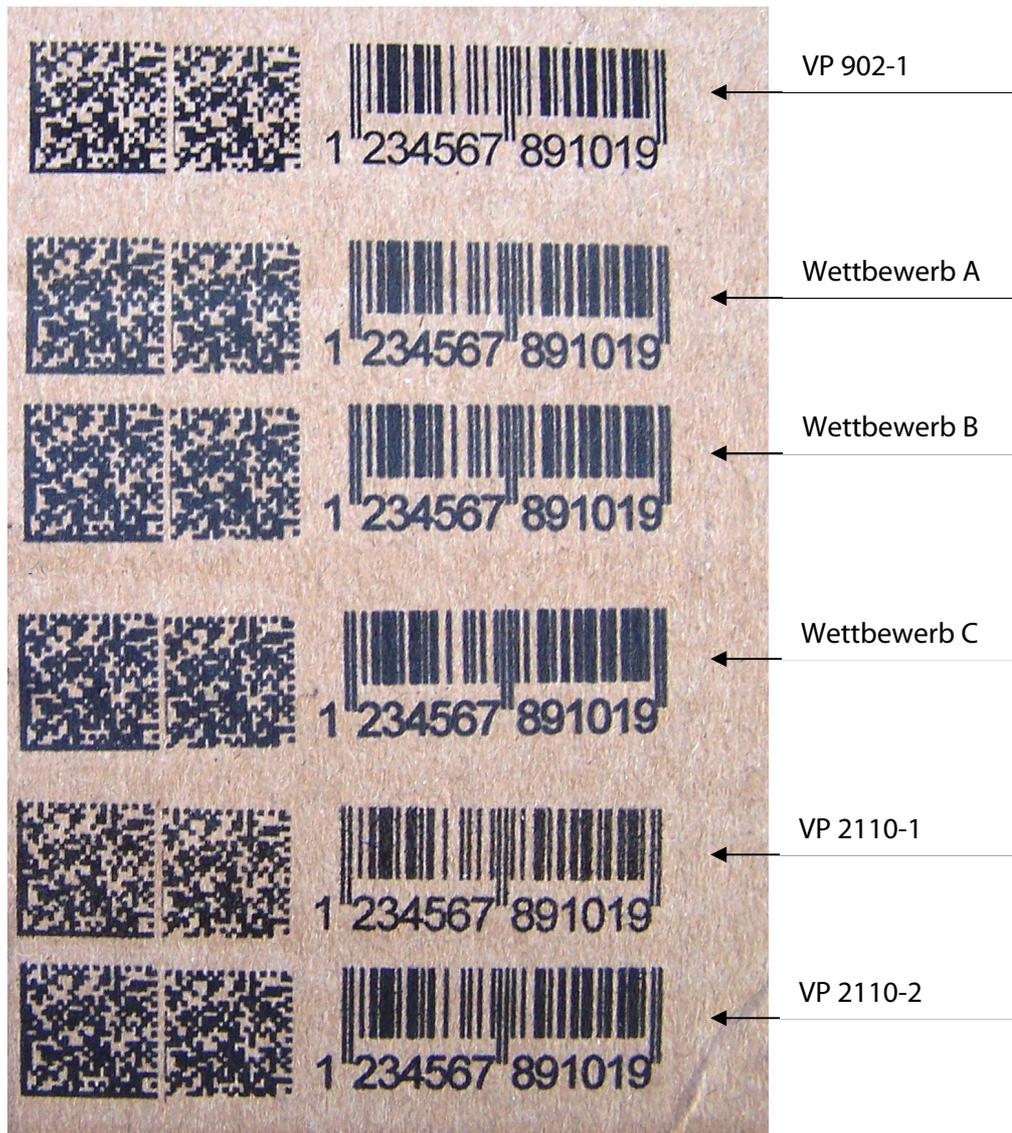
Abbildung 6: Datamatrixcode und Barcode (Tintenvergleich auf Karton)
