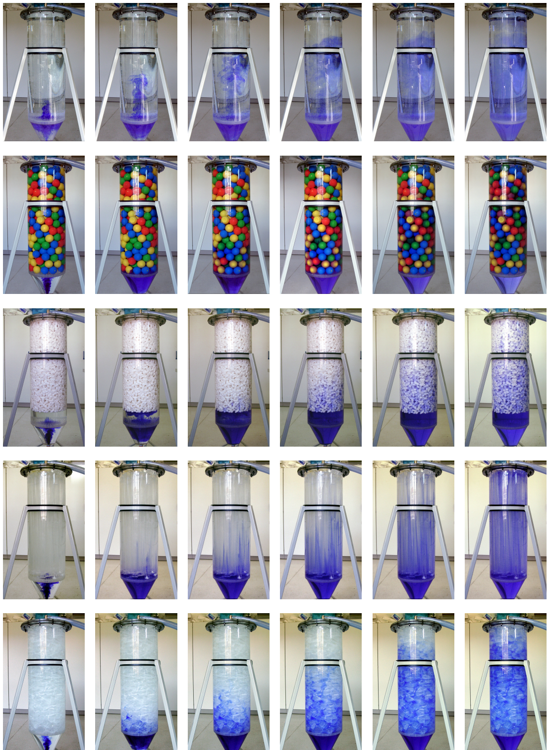
Abbildung 4.10: Bilder der Strömung für den leeren Behälter, Kugelschüttung, Schaumstoff-Flocken, Schlauchbeutel stehend, Schlauchbeutel-Schüttung (von oben nach unten)
