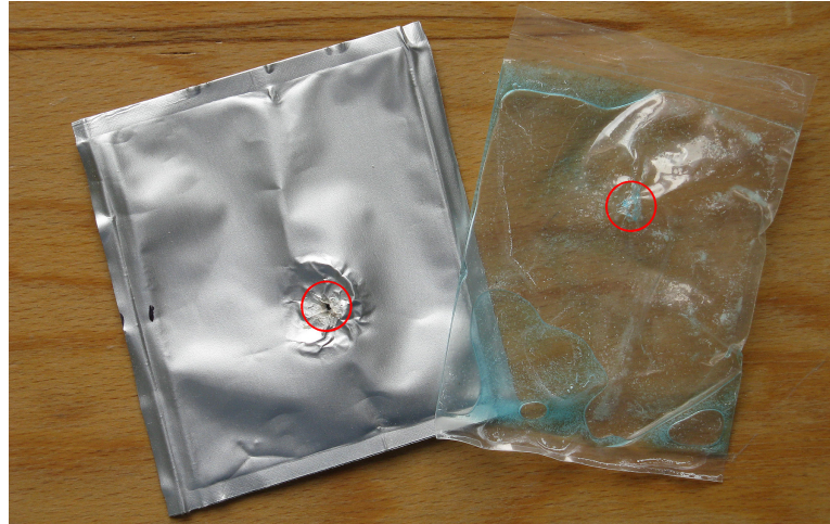
Abbildung 4.17: Beschädigungen der Schlauchbeutel
