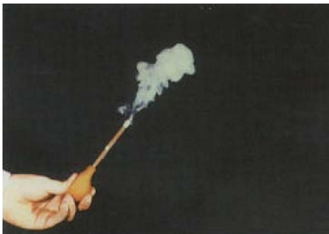
Abb. 71 Strömungsprüfröhrchen im Einsatz
