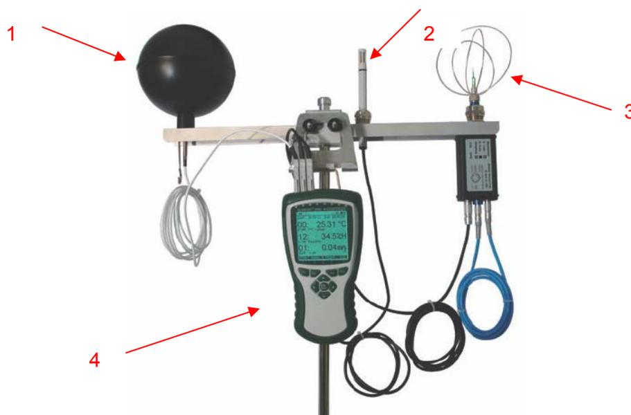
Abb. 75 Aufbau einer Behaglichkeitsmessstation:
