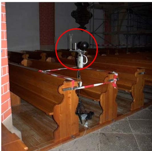
Abb. 74 Behaglichkeitsmessung im Bereich der Bankreihen
