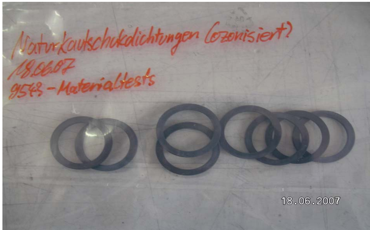
Abbildung 24: Kautschukdichtungen (ozonisiert); äußerlich keine Beschädigungen erkennbar
