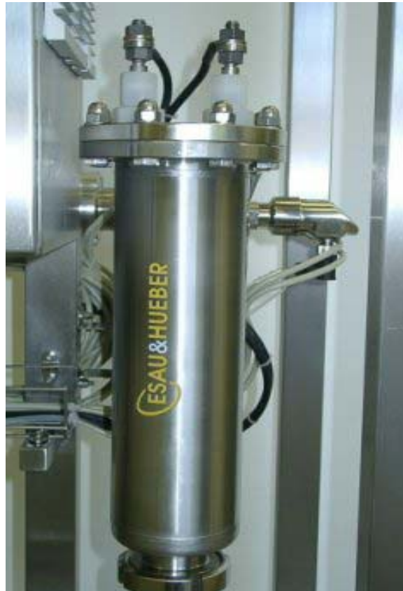
Abbildung 6: Elektrodengehäuse mit Aseptikflansch und –blindflansch und versenktem Elektrodenstack (oben), Stromzufuhr über zwei Klemmen (oben), Temperatursensor (rechts) und Prozessanbindung (oben links und unten) [21]
