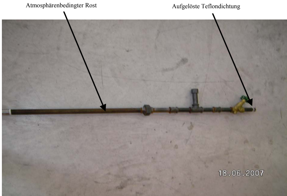
Abbildung 21: Stahl unbehandelt (ozonisiert); atmosphärenbedingt verrostet, aufgelöstes Dichtungsteflon
