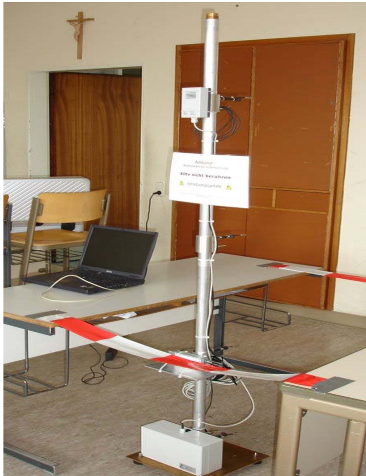
Bild 14: Fotografische Ansicht der Messvorrichtung zur Bestimmung der Raumklimakenngößen in den Klassenräumen. Um die Raumklimaparameter (Temperatur, Feuchte, Strömungsgeschwindigkeit) in verschiedenen Höhen bestimmen zu können, sind die Messsonden entlang eines vertikalen Mastes verschoben worden.
