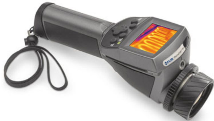
Bild 16: Fotografische Ansicht der Wärmebildkamera, mit welcher die thermographischen Photos gemacht wurden.
