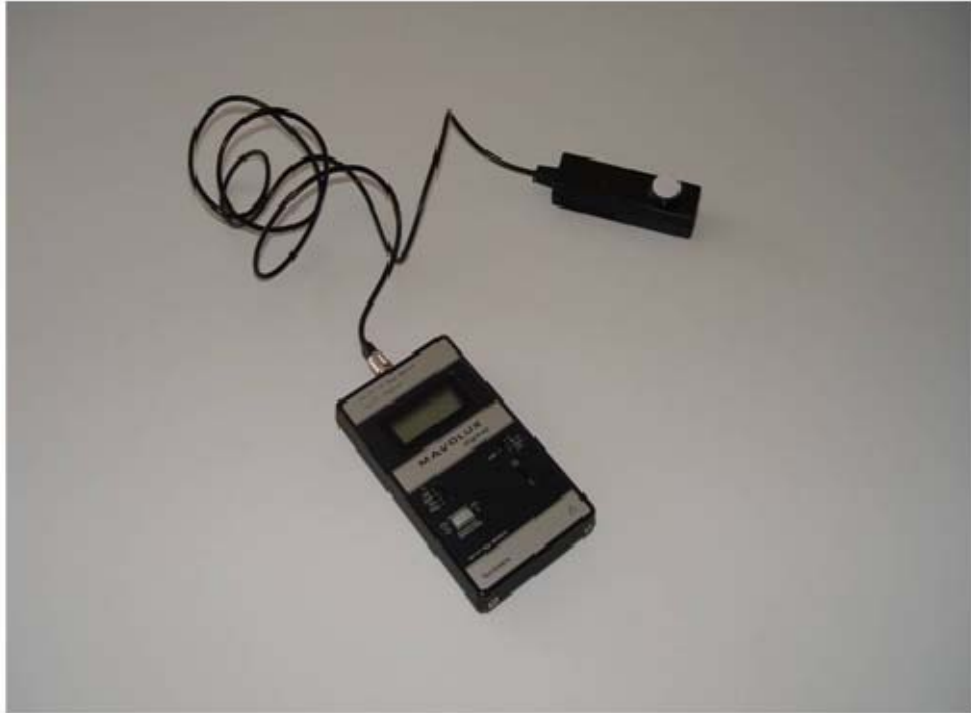
Bild 18: Fotografische Ansicht des Beleuchtungsstärkemessgerätes. Das Gerät besitzt einen Sensor (rechts oben), der in die erforderliche Position, meist horizontal in Tischhöhe, gebracht wird.
