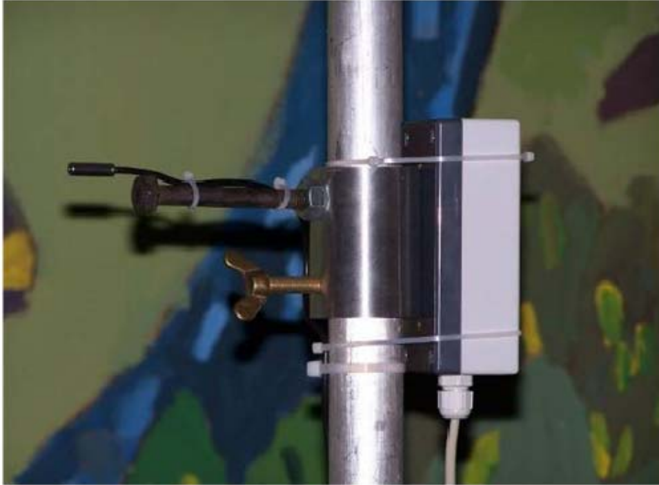
Bild 15: Fotografische Ansicht des CO 2 -Sensors, der zur Messung des Kohlendioxidgehaltes der Raumluft in den Schulräumen verwendet wurde. Der Sensor ist an den gleichen Mast befestigt worden, an dem die übrigen Raumklimakennwerte befestigt wurden (vgl. Bild 14).
