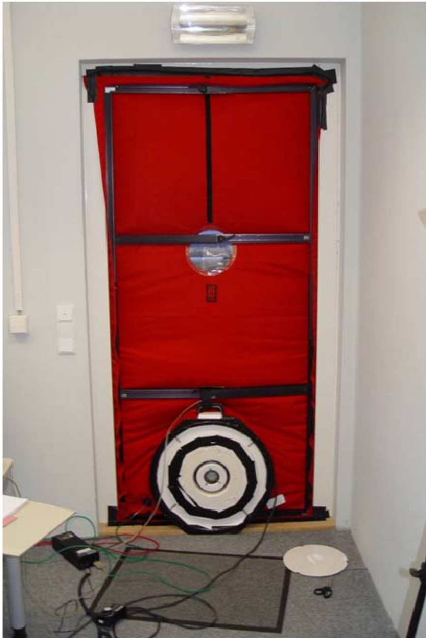
Bild 17: Fotografische Aufnahme der sog. Blower-Door-Messanlage, die zur Luftwechselformung in den untersuchten Räumen verwendet wurde.
