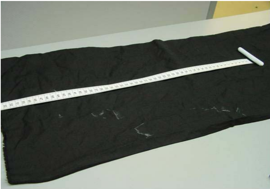
Abbildung 3 sichtbare Zeolith-Rückstände auf schwarzen Baumwoll-Textilien
