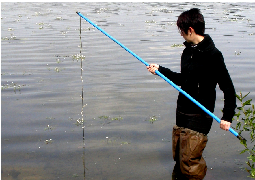
Abb. 4: Messung der Gewässertrübung im Tiefenprofil mit Hilfe eines Lichtsensors. (Foto: H. John, 09.06.2006).
