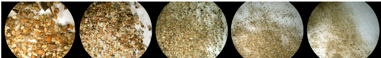
Abb. 3: Beispiel einer Röschenprobe fraktioniert von >1000 µm (links) bis <125 µm (rechts)
