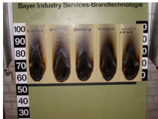
Abb. 3-4: B2-Prüfung: Schadensbild Multitec ® [7]
