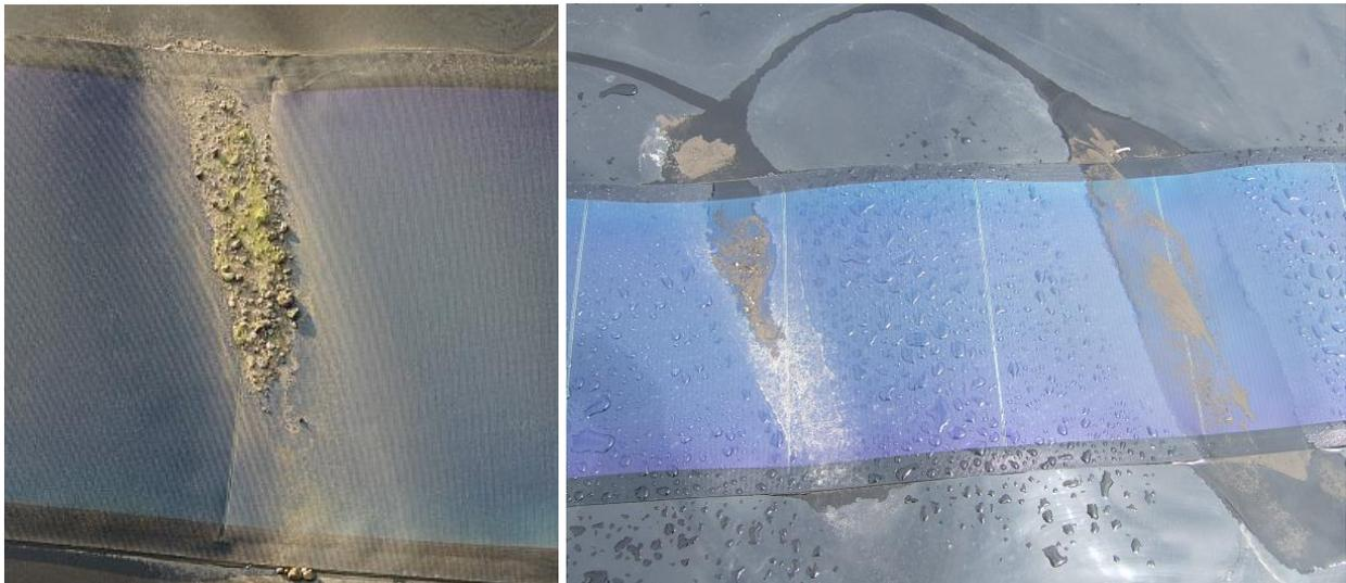
**Abbildung 8-1 Schmutzablagerung auf nicht angeschlossenen Prototypen der PE-HD Verbunde**
