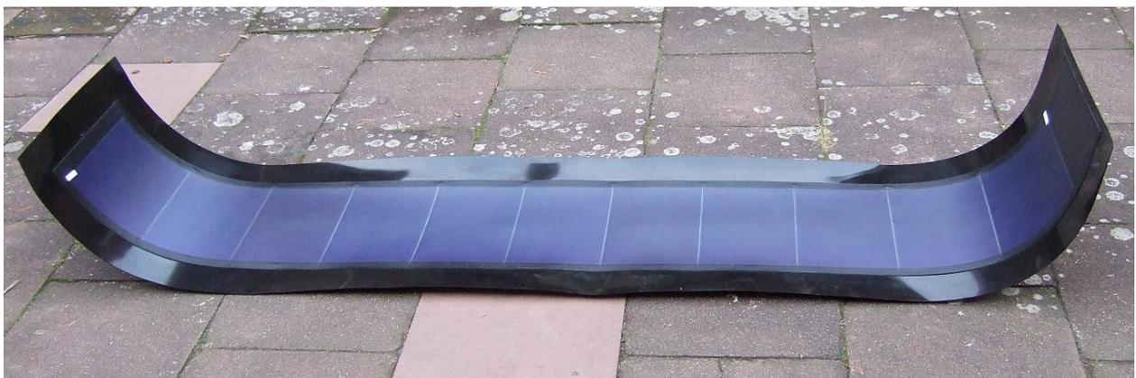
**Abbildung 3-4 KDB mit aufgeklebten UniSolar Modul (Länge 3 m)**
