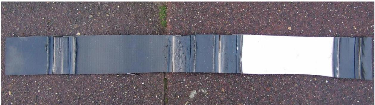
**Abbildung 3-10** Aus dem Schweißgefüge geschnittene Probe
