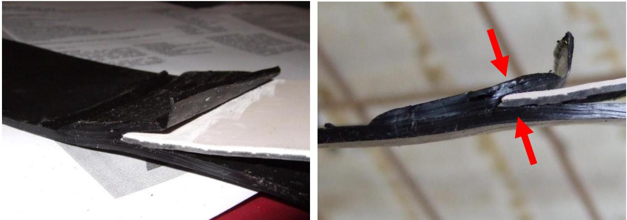
**Abbildung 3-11** Querschnitt Dachbahn-KDB-Verschweißung mit abgelöstem Extrudat
