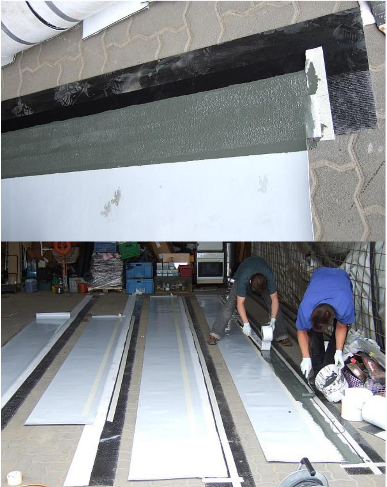
Abbildung 3-16 Fertigung eines Adapterstreifens für die Alwitra Testfelder
