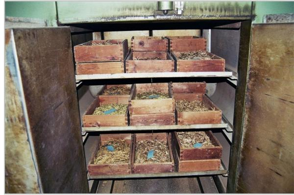
Abb. 18: Trocknung des gehäckselten Materials (Mischproben) im Trockenschrank
