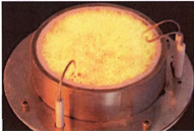
Bild 1.2: Verbrennungsregion des Porenbrenners von promeos GmbH
